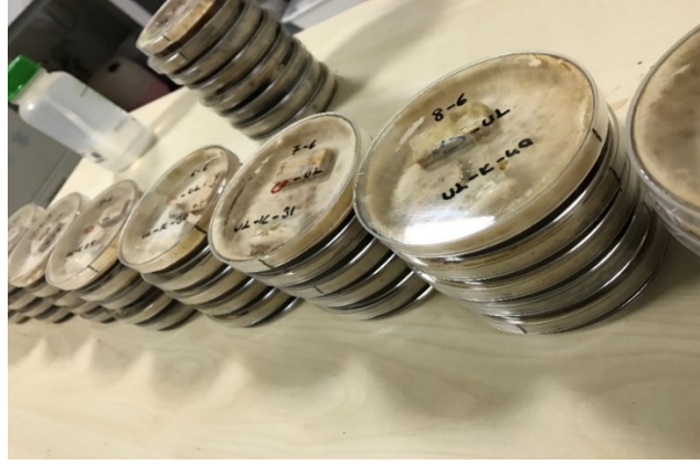
Şekil 3.11 : Petri kabında üremiş ve örnekleri kaplamış C.puteana mantarı
