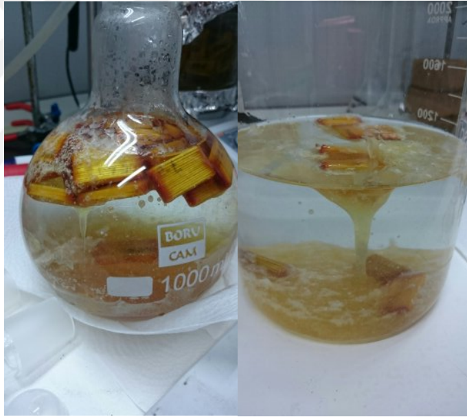
Şekil 3.4 : 7.Grup reaksiyon sonrası hali/ Reaksiyon sonrası örneklerin saf su içerisine dökülerek yıkanması
