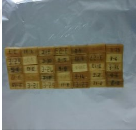
řekil 3.2 : 3.Grup örneklerin kürleme öncesi alüminyum folyo üzerine dizilmesi
