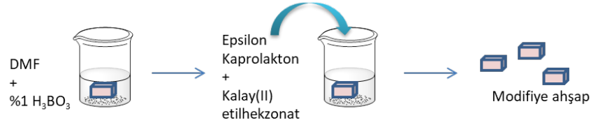
Şekil 3.1 : Ahşap numunelerin %1'lik borik asit ( H_3BO_3 ) ve \epsilon -kaprolakton ile DMF ortamında modifikasyon yöntemlerinin gösterimi
