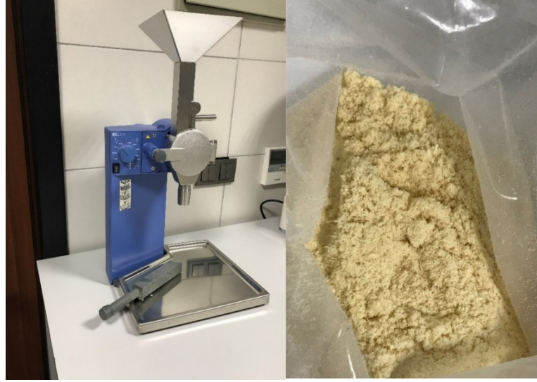
Şekil 3.13 : Un haline getirmeyi sağlayan MF 10 basic Microfine grinder drive ve ahşap unu örneği
