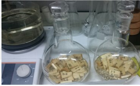
Şekil 3.6 : Örneklerin DMF içerisinde bekletilmesi
