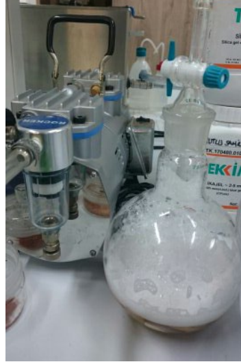
Şekil 3.8 : Reaksiyon öncesi örneklere vakum yardımıyla \epsilon -kaprolakton emdirilmesi
