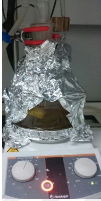
Şekil 3.3 : Reaksiyonun manyetik karıştırıcı 11 ısıtıcı üzerine reaksiyona sokulması
