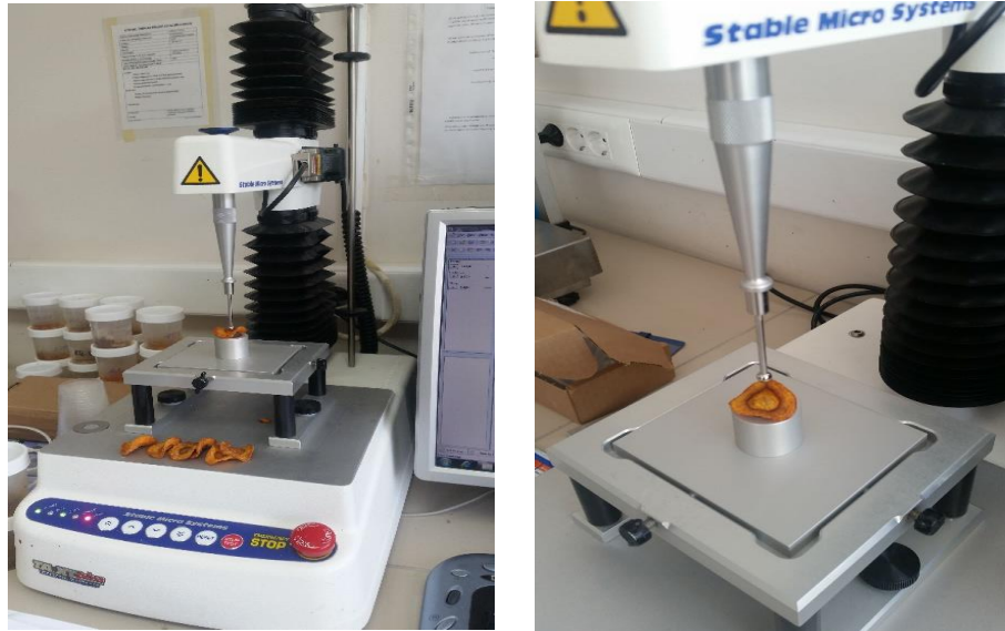
Şekil 3.12 : Tekstür analiz cihazı
