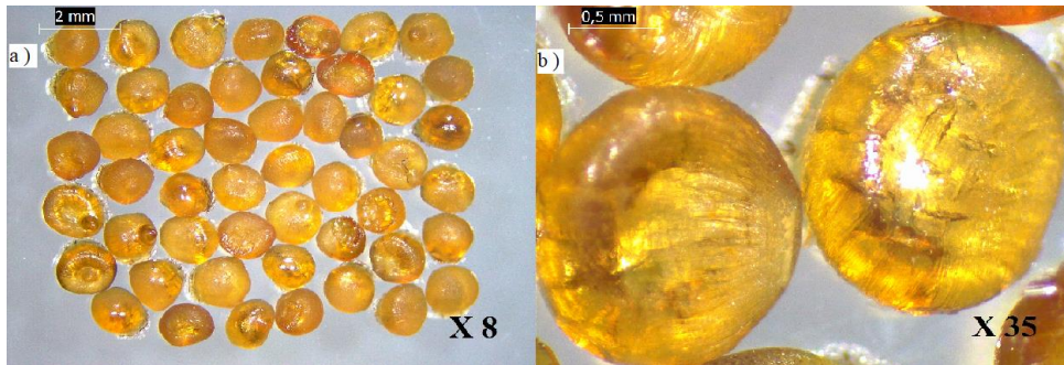
Şekil 3.3 : İyonik jelleşme yöntemi ile sodyum aljinat (%2 w/v)/jelatin (%5 w/v) kaplama materyali kullanılarak elde edilen kapsüllerin x8 (a) ve x35 (b)’deki mikroskobik görüntüleri
