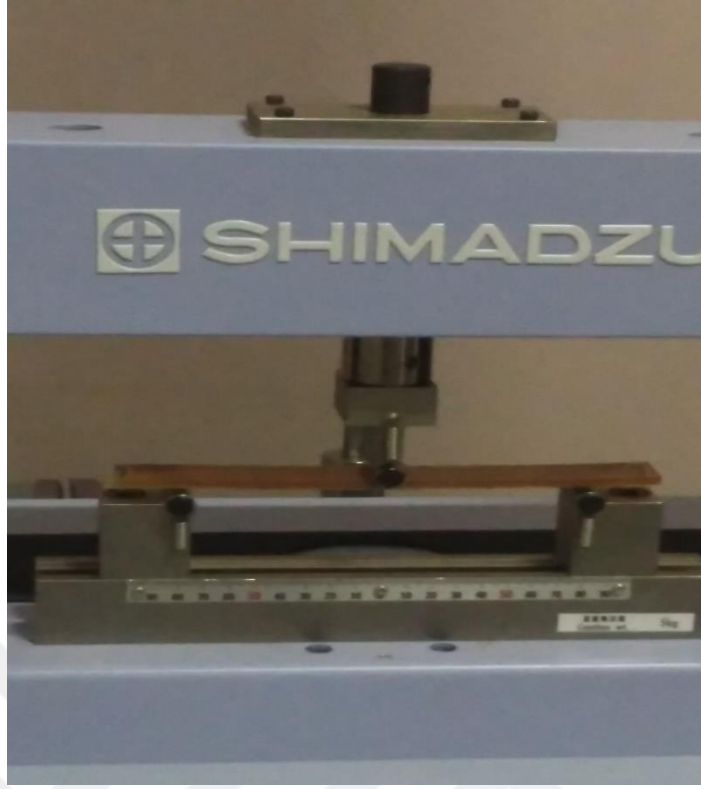
Şekil 3.17 : Biyokompozit üç nokta eğme testi.
