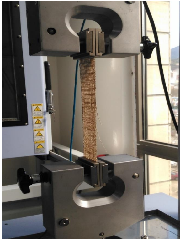
Şekil 3.20 : Jüt kumaşı çekme deneyi.
