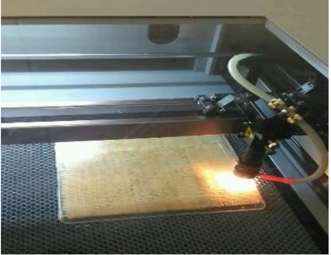
Őekil 3.11 : Kare numunenin lazer kesimle hazırlanması.
