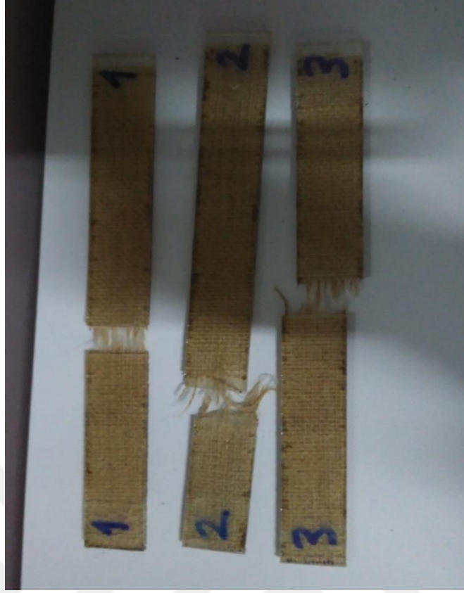
Şekil 3.16 : Test edilmiş jüt/PLA kompoziti çekme numuneleri.
