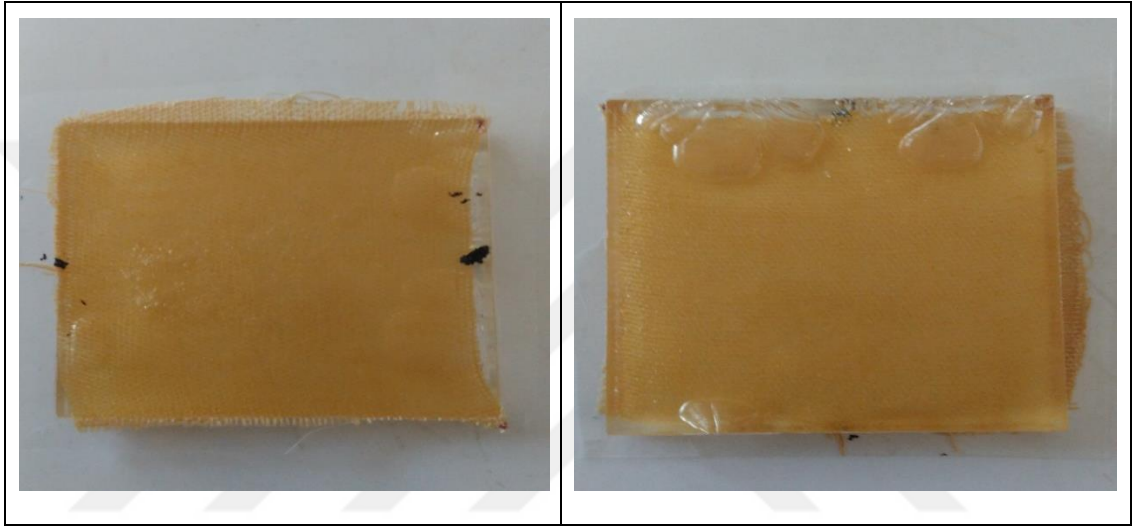
Şekil 3.4 : Ön test deneyi sonucu üretilen PLA/Keten kompozitinin üstten ve alttan sırayla görüntüsü.
