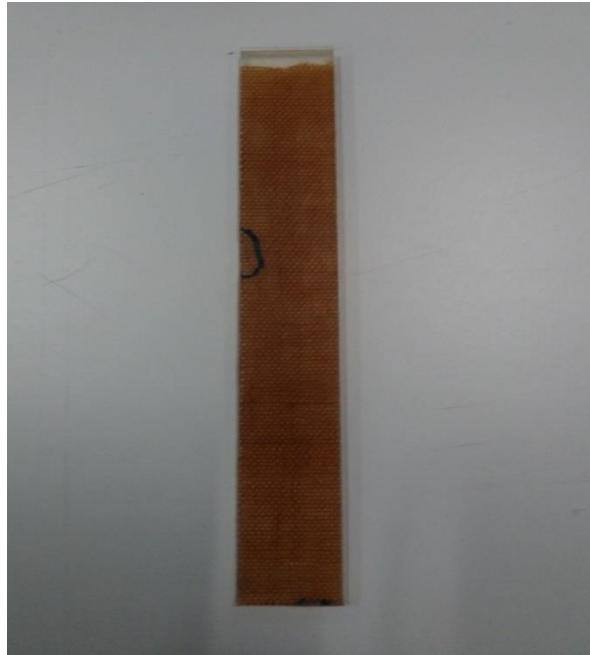
Őekil 3.12 : ekme ve  nokta eđme testi numunesi.
