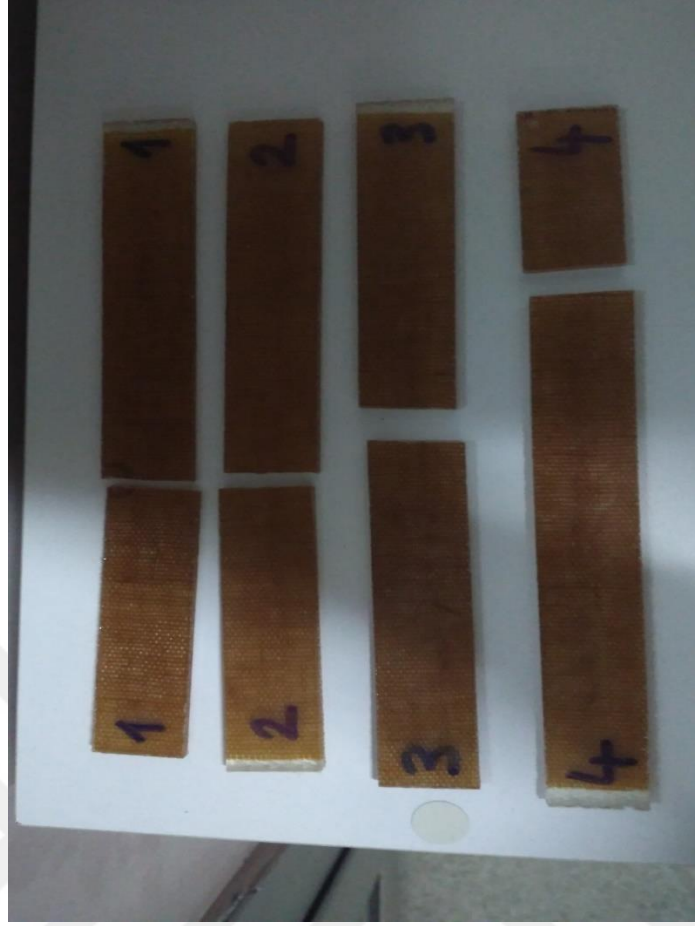
Şekil 3.15 : Test edilmiş keten/PLA kompoziti çekme numuneleri.
