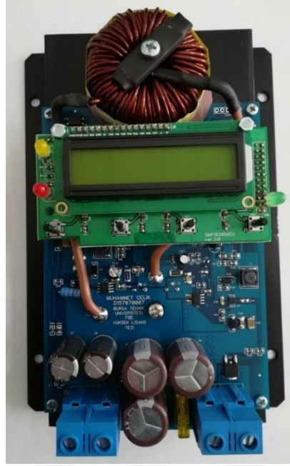
Şekil 4.4 : Soğutucu üzerine yerleştirilen devrenin son hali.
