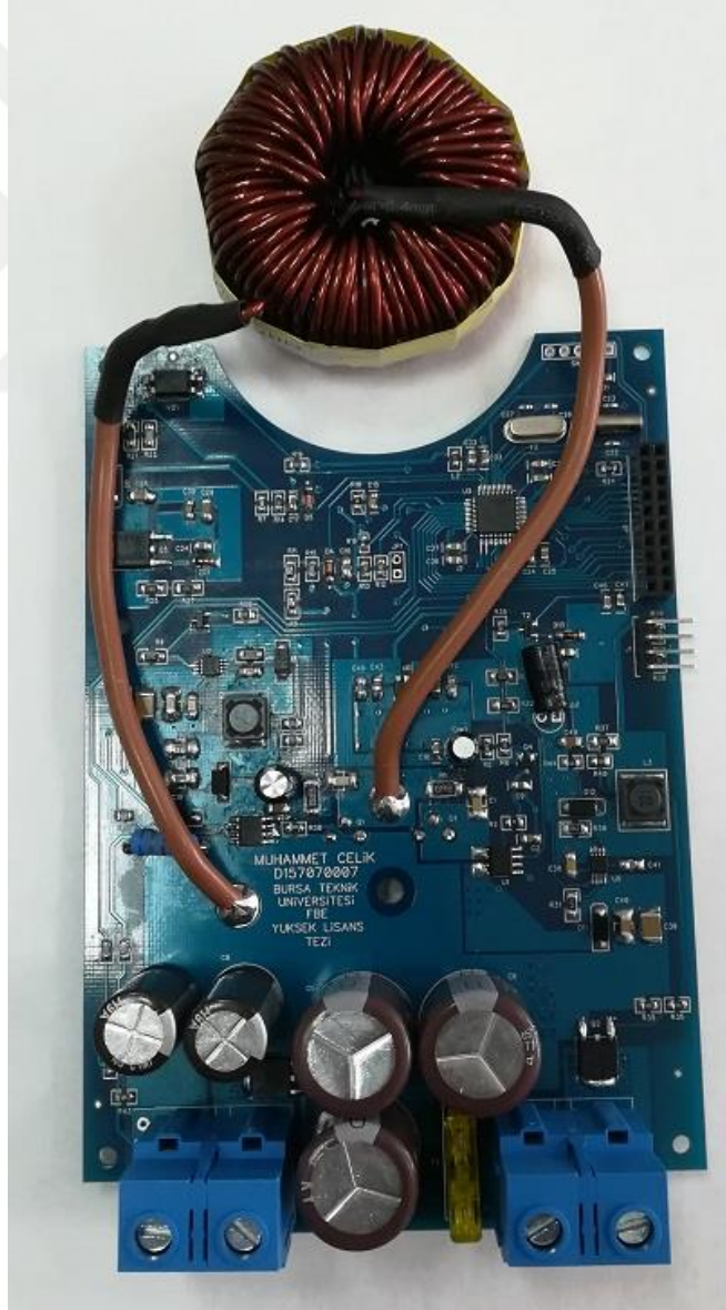
Şekil 4.1 : Yükselten çevirici topolojisine sahip MPPT solar şarj kontrol cihazı.
