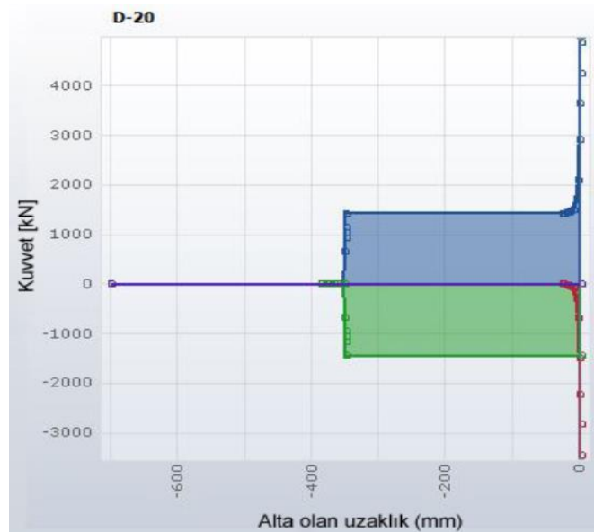
Şekil 3.36 : JAC980YL malzemeli kapı kirişinin süzdürme çubuğu ile gerçekleştirilen şekillendirme kuvvet değerleri
