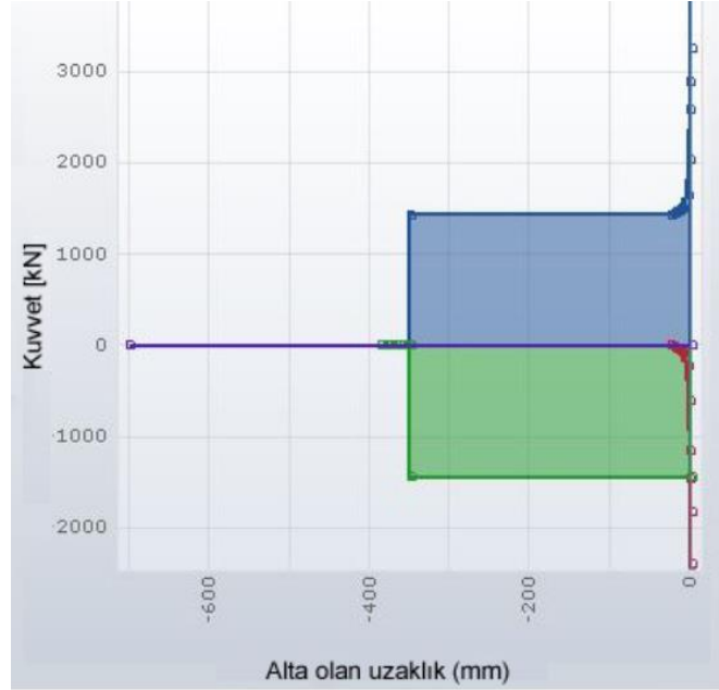
Şekil 3.39 : JAC980YL malzemeli kapı kirişi için pot kuvveti arttırılmış şekillendirme kuvvet değerleri
