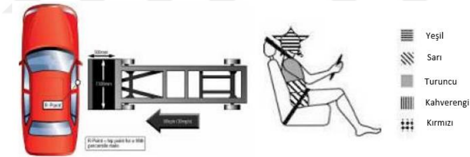
Şekil 1.1 : %100 önden çarpışma testi şematik gösterimi [2]
