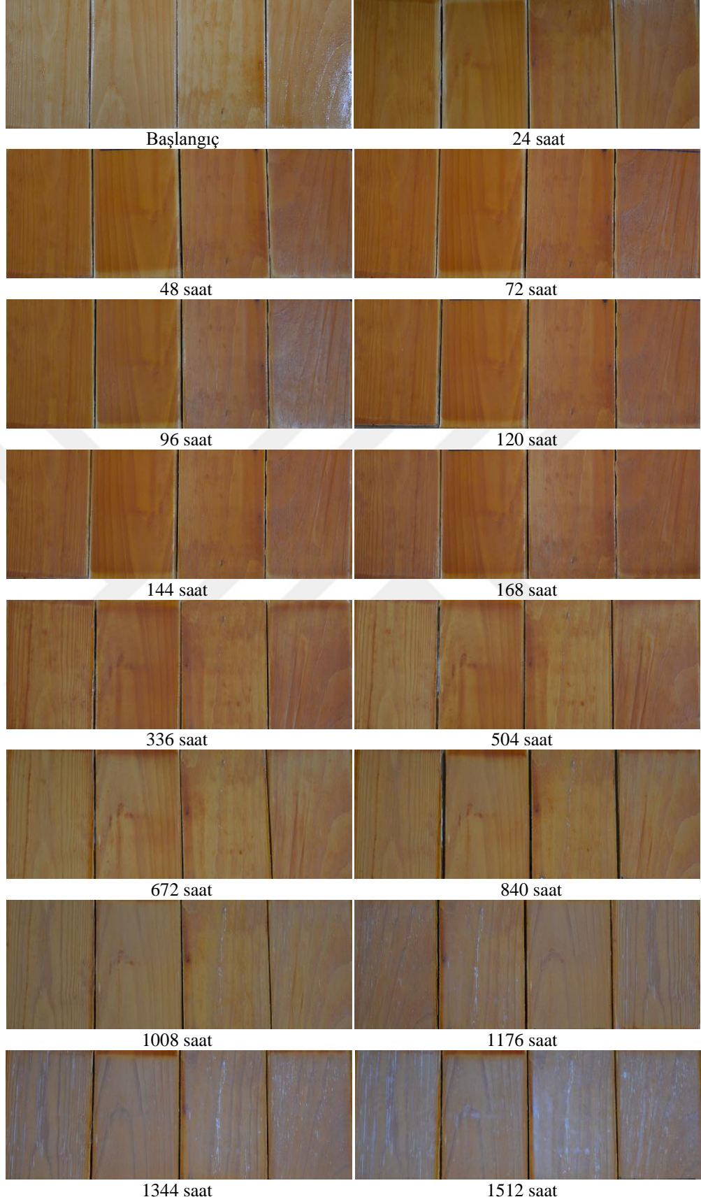
Şekil 4.21: %1 kıızılcam kabuk taneni + şeffaf ÜYM ile yüzeyi kapatılan örneklerin hızlandırılmış dış ortam testi sonrası fotoğrafları
