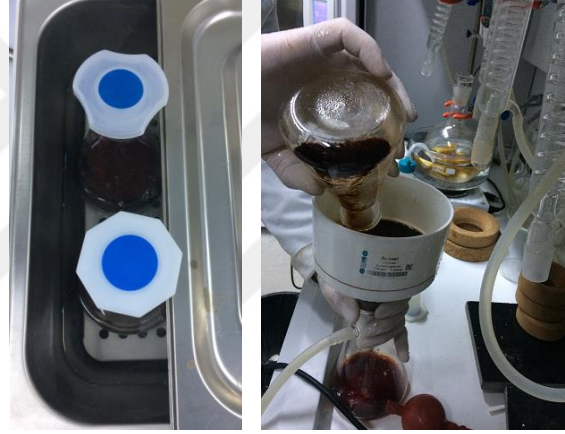
Şekil 3.2: Kızılçam kabuğunun ekstraksiyon işlemi
