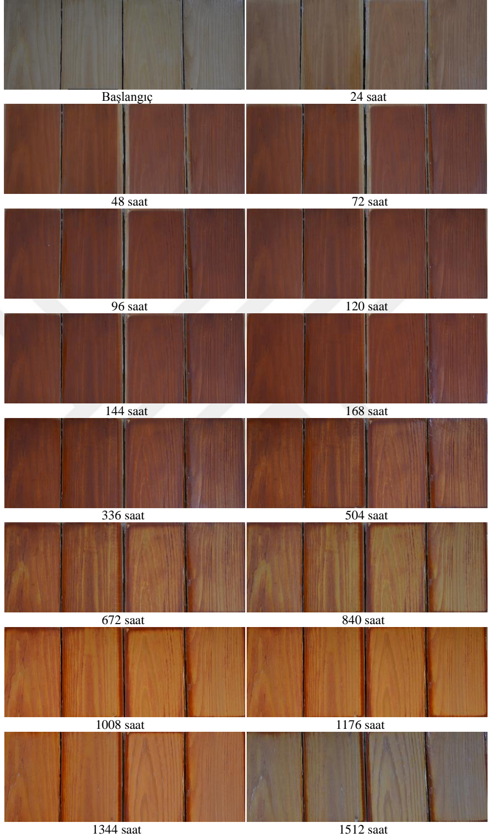
Şekil 4.18: %3 mimoza taneni + şeffaf ÜYM ile yüzeyi kapatılan örneklerin hızlandırılmış dış ortam testi sonrası fotoğrafları
