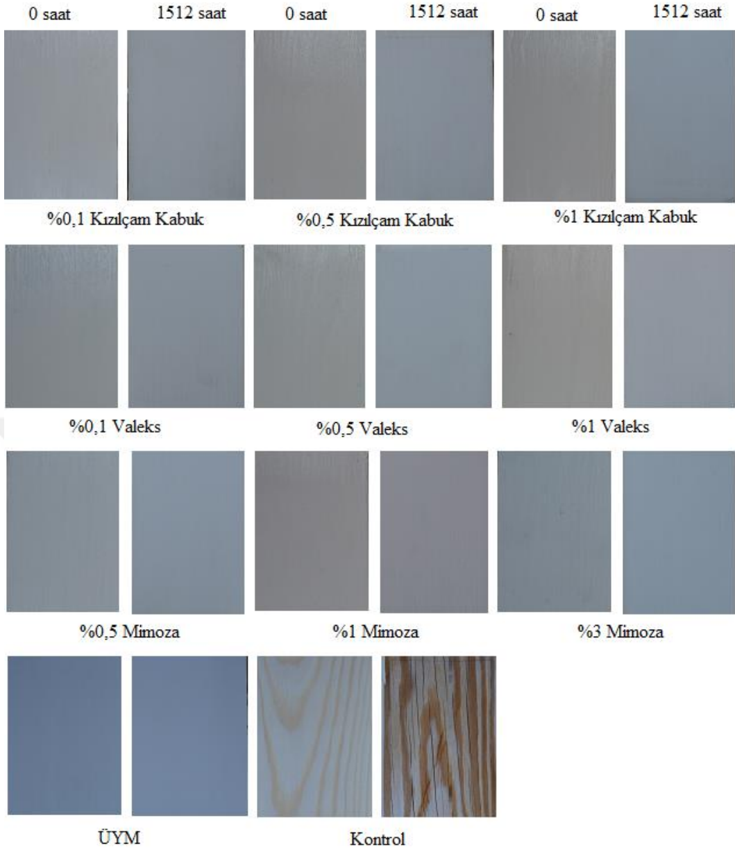
Şekil 4.25: Opak boyalı örneklerin başlangıç ve 1512 saat sonraki görünüşleri
