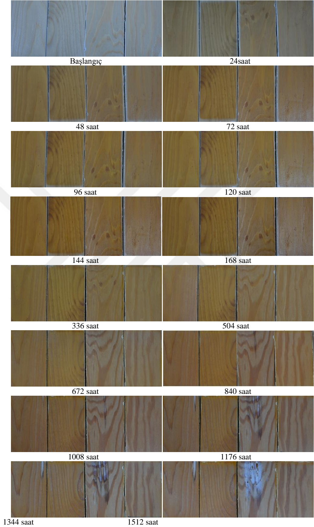
Şekil 4.16: %0,5 mimoza taneni + şeffaf ÜYM ile yüzeyi kapatılan örneklerin hızlandırılmış dış ortam testi sonrası fotoğrafları
