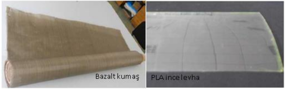
Şekil 2.1 : Kompozit yapımında kullanılan basalt kumaş ve PLA ince levha (Lv vd., 2012).
