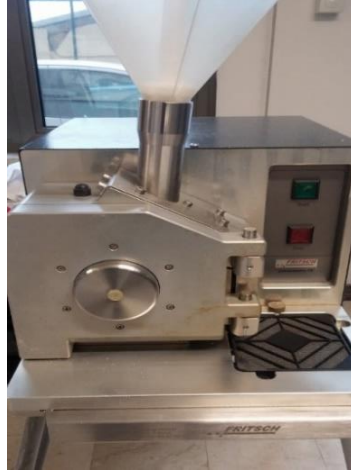
Şekil 3.4 : Fritsch Pulverisette 19 öğütücü makinesi
