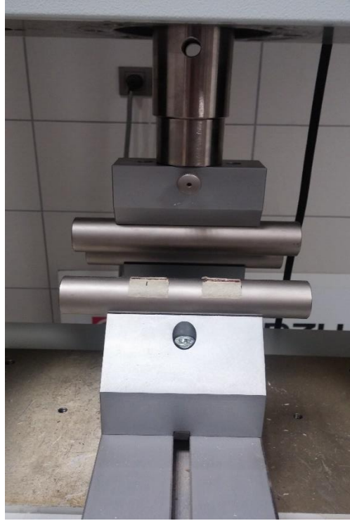
Şekil 3.13 : Shimadzu universal test cihazı eğilme testi aparatları
