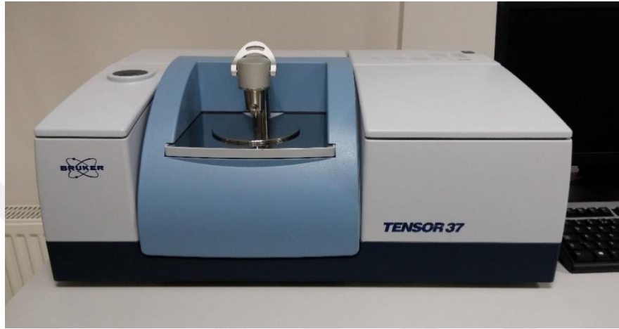
Şekil 3.19 : Bruker Tensor 37 FTIR analiz cihazı
