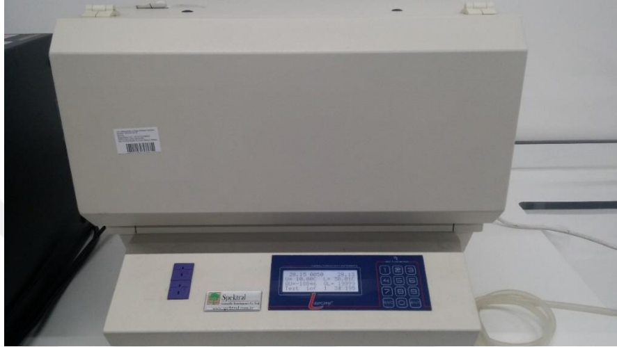
Şekil 3.17 : Fox 314 laser comp. ısıl iletkenlik katsayısı ölçüm cihazı
