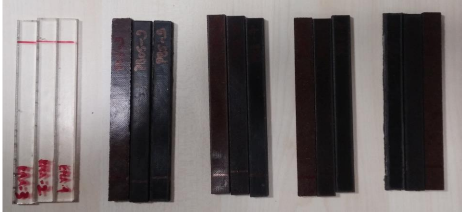
Şekil 3.15 : HDT analizi test numuneleri
