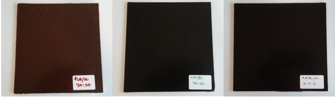
Şekil 3.9 : Biyokompozitlerin levha şeklinde kalıplanmış hali (20x20 cm)
