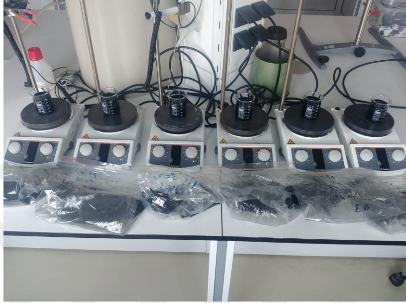
Şekil 3.2.12: Metilen mavisi adsorpsiyon deney düzeneği.
