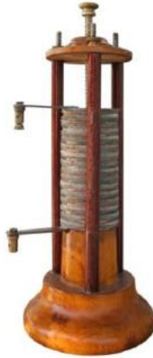
Şekil 1.3 : Tarihte bilinen ilk voltaj pili.
