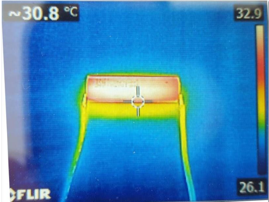
Şekil 4.13 : Termal kamera ile ölçülen batarya yüzeyi sıcaklık dağılımı.
