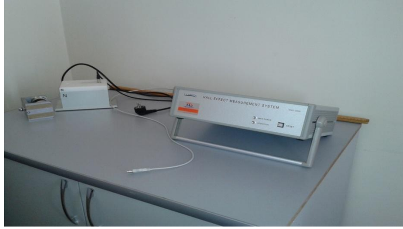
Şekil 3.9. Ecopia Hall etkisi ölçüm sistemi
