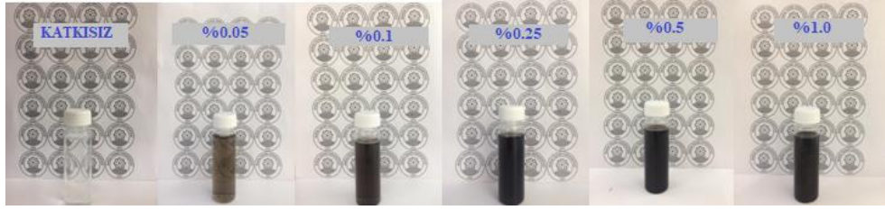
Şekil 2.3: rGO/PVA Nanokompozit Çözeltilerinin Görüntüleri.
