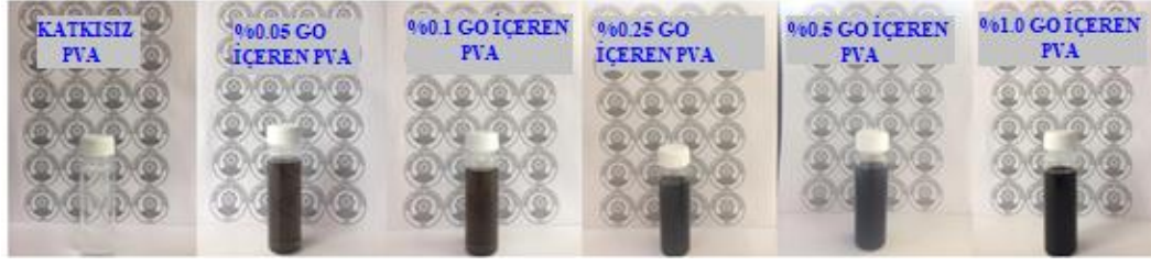
Şekil 2.1: GO/PVA Nanokompozit Çözeltilerinin Görüntüleri.
