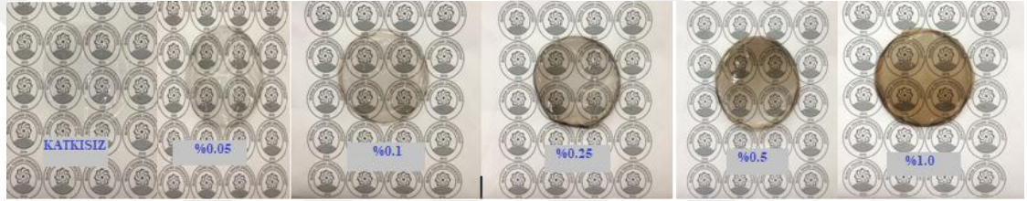
Şekil 2.2: GO/PVA Nanokompozit Filmlerin Görüntüleri.
