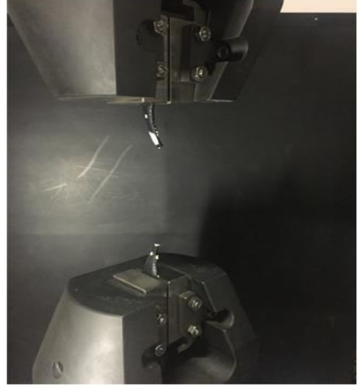
Şekil 4.8: Cihaz üzerindeki numunenin uzama ve kopma anı.
