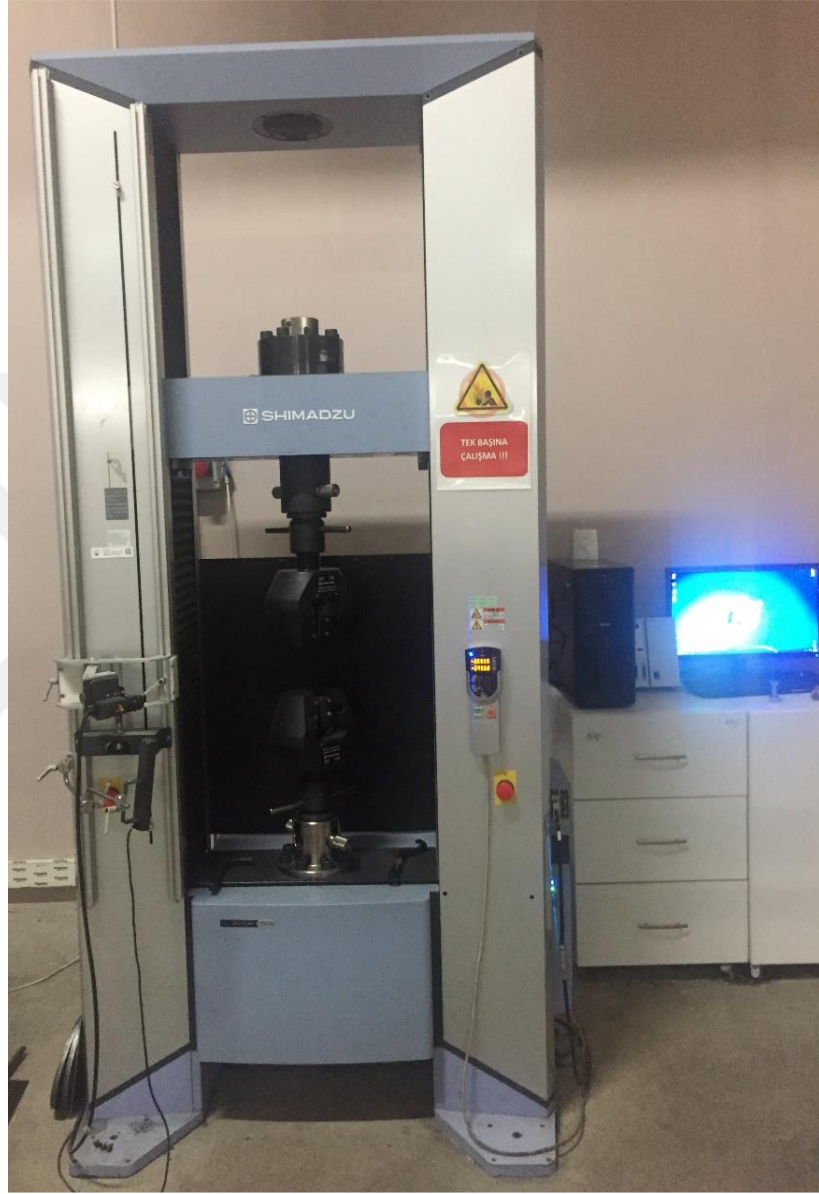
Şekil 4.6: BTÜ Makine Laboratuvarında yer alan çekme testi cihazı.
