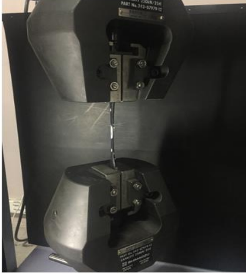
Şekil 4.8: Cihaz üzerindeki numunenin uzama ve kopma anı.
