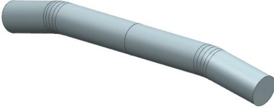
Şekil 4.2: Hortum kalıbının geometrisi.
