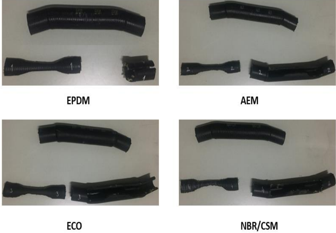
Şekil 4.4: Hortum üzerinden kesilen çekme numuneleri.
