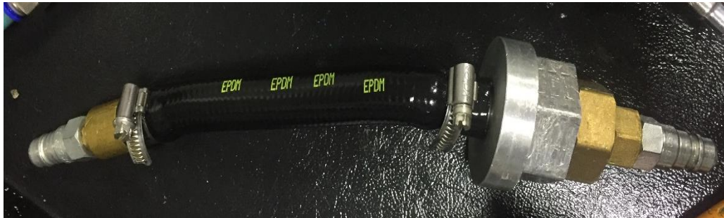
Şekil 3.7: Vidalı kelepçe ile monte edilmiş tapalı hortum.
