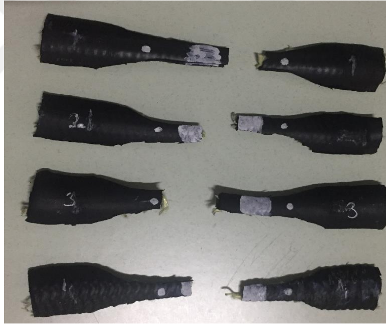
Şekil 4.9: Çekme testi sonucunda kopan numuneler.
