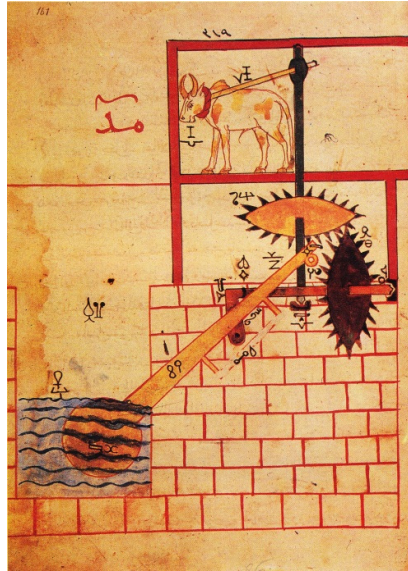
Şekil 22. Hayvan Gücünden Yararlanarak Suyu Yukarı Çıkaran Araç
