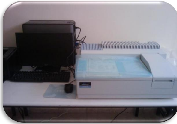
Şekil 4.19. UV-vis ölçümlerinin yapıldığı Perkin Elmer lamda-25 fotospektrometre
