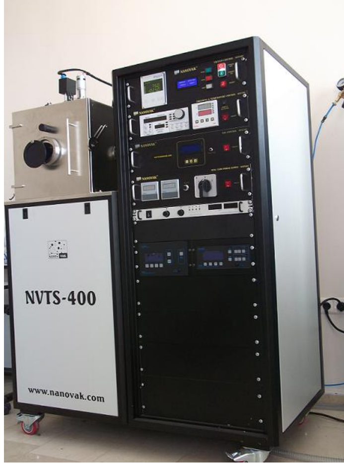
Şekil 4.22. Termal buharlaştırma işlemlerinin gerçekleştirildiği vakum sistemi
