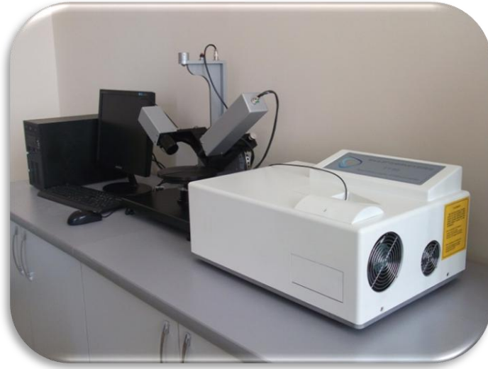
Şekil 4.20. PHE-102 Spektroskopik Elipsometre
