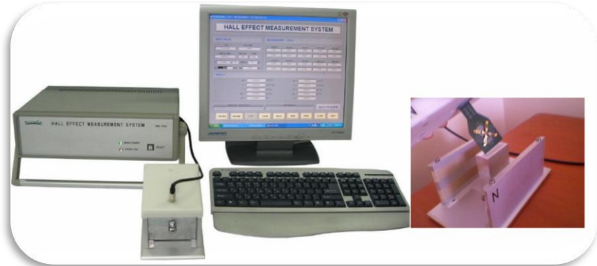
Şekil 4.21. HMS-3000 Hall Etkisi Ölçüm Sistemi
