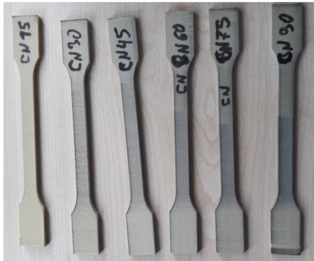
Şekil 2.8 : Çekme deneyine hazırlanmış PEKK numuneleri
