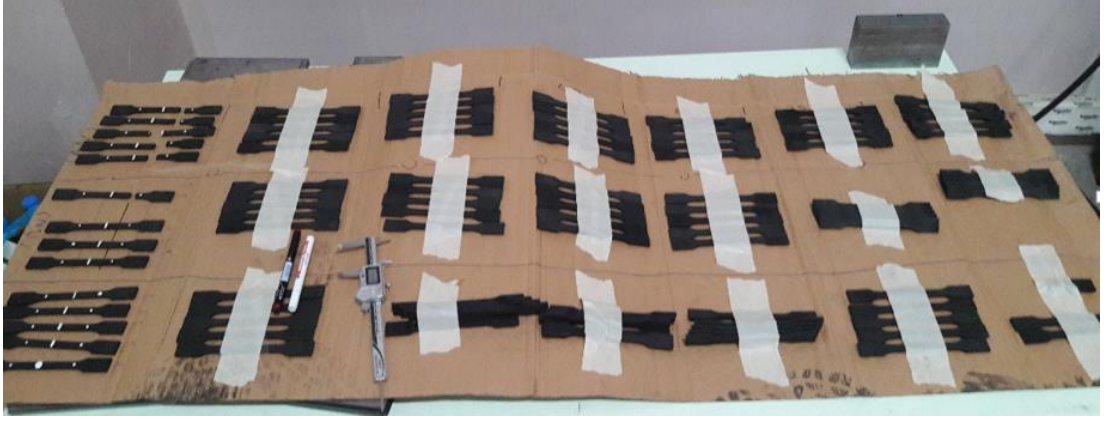
Şekil 2.7 : Çekme deneyine hazırlanmış PACF numuneleri
