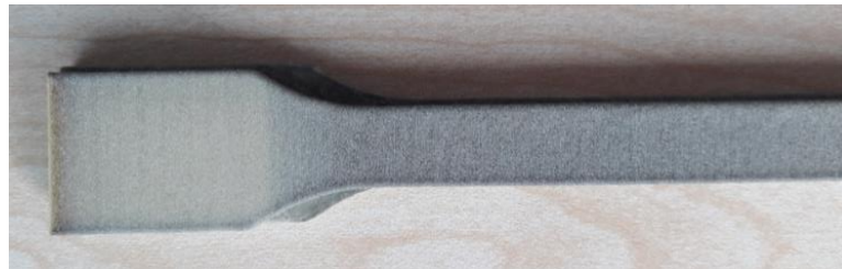
Şekil 3.21 : Standartta uygun ölçülerde üretilmemiş PEKK çekme numuneleri
