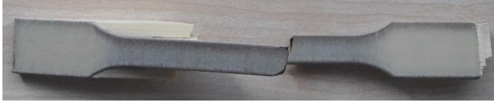
Şekil 3.20 : Standartta uygun üretilmemiş PEKK çekme numuneleri
