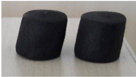
Şekil 3.13 : Standarda uygun üretilmemiş PACF basma numuneleri
