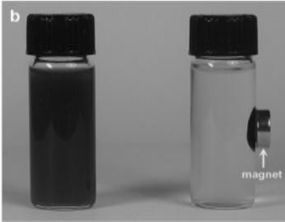
Şekil.3.3. Manyetik reçinenin manyetik alan ile etkileşimi
