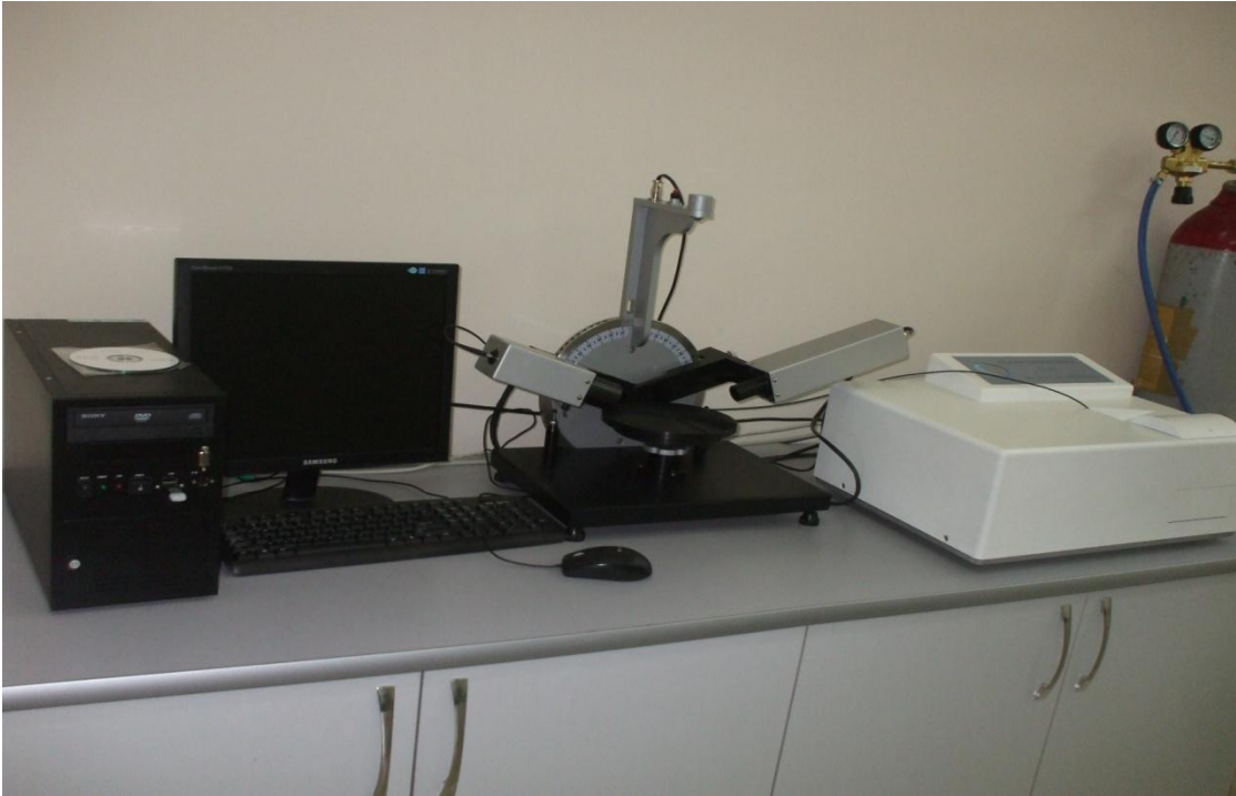
Şekil 3.21. oc- ZnPc ince filminin kalınlığının ölçüldüğü PHE102 Elipsometre cihazı
