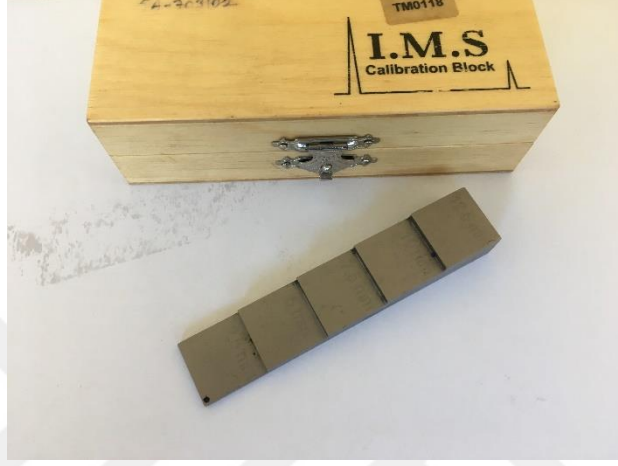
Şekil 2.1 : Kullanılan kalibrasyon bloęu
