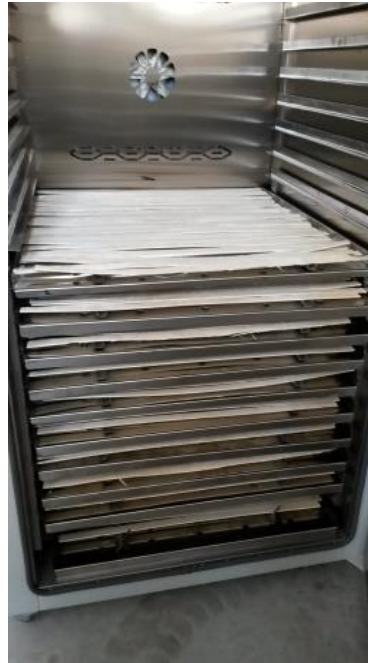
Şekil 2.8 : Etüvde kurutulan kaplama şeritler.
