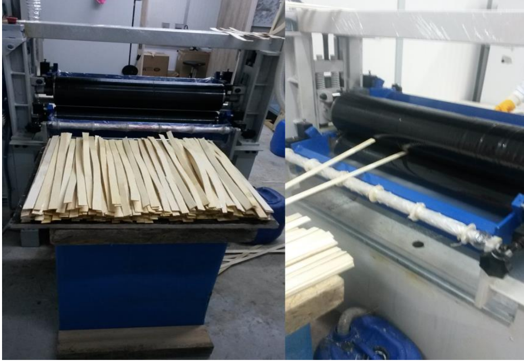
Şekil 2.9 : Şeritlerin tutkallanması ve taslak haline getirilmesi.
