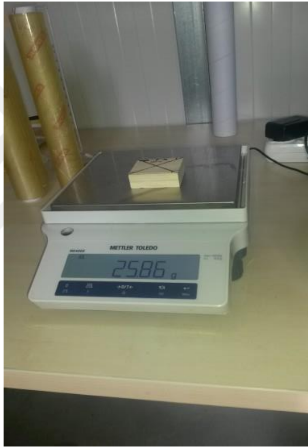
Şekil 2.13 : Su alma miktarının belirlenmesi ve 0,01 hassasiyetteki terazi.
