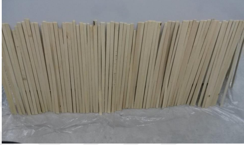
Şekil 2.7 : 24 saat oda sıcaklığında bekletme işlemi.
