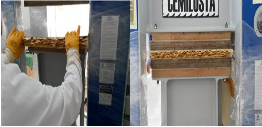
Şekil 2.10 : Taslak haline getirilmiş şeritlerin preslenmesi.
