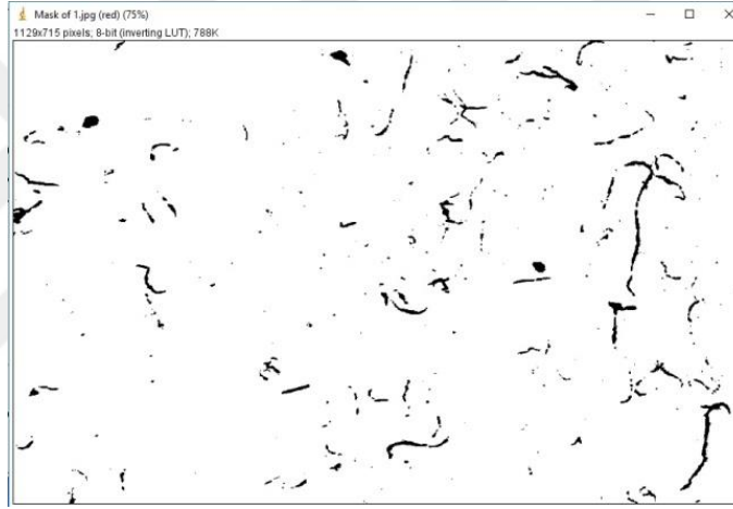
Şekil 3.13: Kimyasal 1 ile üretilen Ürün B'ye ait yüzey tozlanma ölçüm fotoğrafları- ImageJ programında işlenmesi sonrası fotoğraf.
