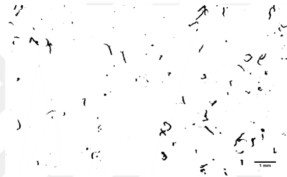
Şekil 3.8: Bıçak dizaynı 1 ile üretilen Ürün C'ye ait yüzey tozlanma ölçüm fotoğrafları-ImageJ programında işlenmesi sonrası fotoğraf.
