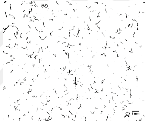
Şekil 3.5: Bıçak dizaynı 1 ile üretilen Ürün B'ye ait yüzey tozlanma ölçüm fotoğrafları-ImageJ programında işlenmesi sonrası fotoğraf.
