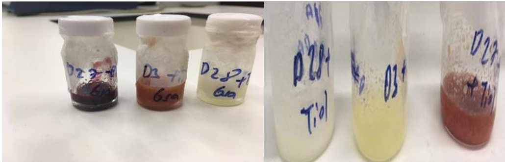
Şekil 5.1 : Kesikli ve yarı kesikli 2:1 fenol:aseton molar oranda ve 10:1 kesikli yapılan denemelerden alınan örnekler.
