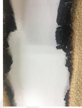
Şekil 3.2: Buğday kapçığı katılmış kaplamalı kumaşın yanma sonrası görüntüsü.
