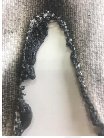
Şekil 3.1: Buğday kapçığı katılmamış kaplamalı kumaşın yanma sonrası görüntüsü.
