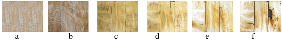
Şekil 4.71: Mazel test örneklerinin hızlandırılmış yaşlandırma sonrasında makroskobik değerlendirilmesi (a: kontrol, b:20. saat, c:48. saat, d:144. saat, e:1008. saat, f:1512. saat).
