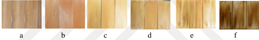
Şekil 4.11: Okaliptüs test örneklerinin hızlandırılmış yaşlandırma sonrasında makroskopik değerlendirmesi (a: kontrol, b:4. saat, c:12. saat, d:60. saat, e:168. saat, f:1512. saat).
