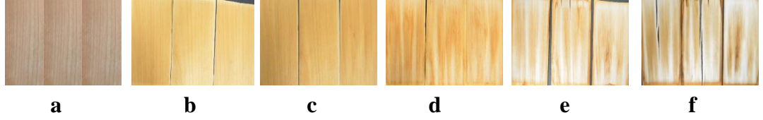
Şekil 4.35: Meşe test örneklerinin hızlandırılmış yaşlandırma sonrasında makroskobik değerlendirmesi (a: kontrol, b:6. saat, c:72. saat, d:168. saat, e:420. saat, f: 1512. saat).
