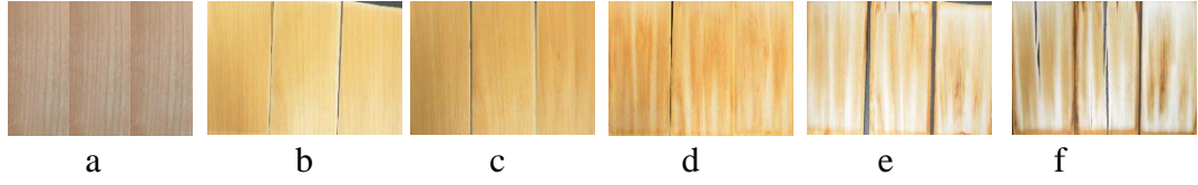
Şekil 4.23: Kiraz test örnekleri hızlandırılmış yaşlandırma sonrasında makroskobik değerlendirmesi (a: kontrol, b:12. saat, c:48. saat, d:108. saat, e:168. saat, f:1512. saat).
