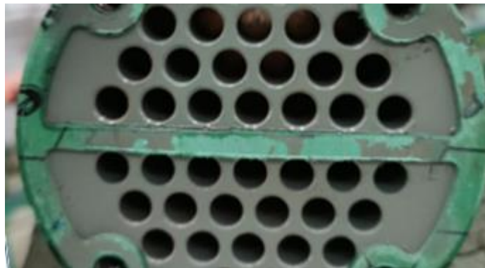
Şekil 5.14 : Klingrit conta ile sızdırmazlık önlemi alınmış olan ayna.
