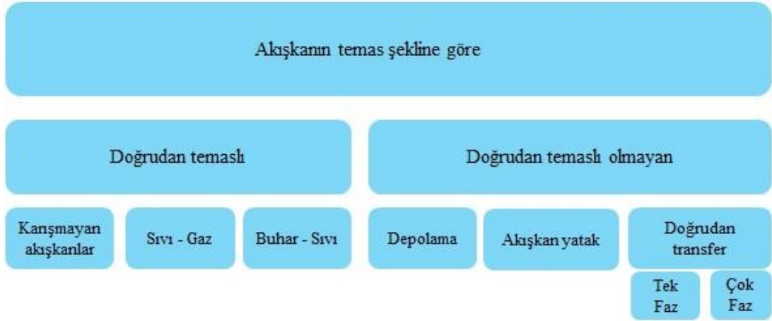
Şekil 2.1 : Akışkanın temas şekline göre ısı transferi.
