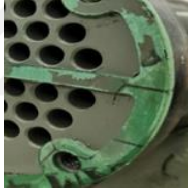
Şekil 5.13 : Havşa işleminden sonra ayna.
