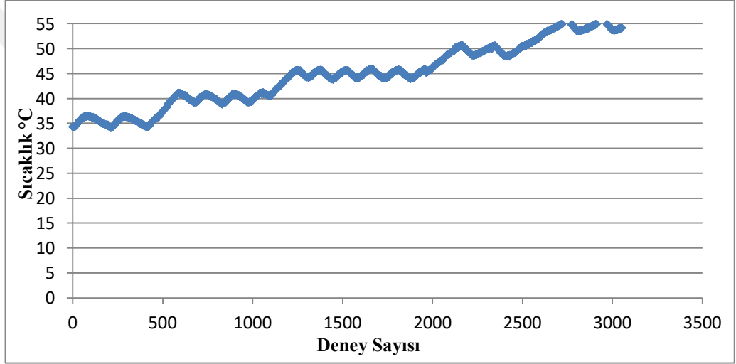
Şekil 6.4 : PID değerlerinin, '1:0,001:0' olması durumunda kontrolör performansı.
