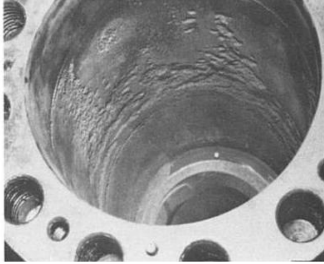
Şekil 1.11 : Erozyon korozyonu ile metalde meydana gelen aşınma örneği [8].
