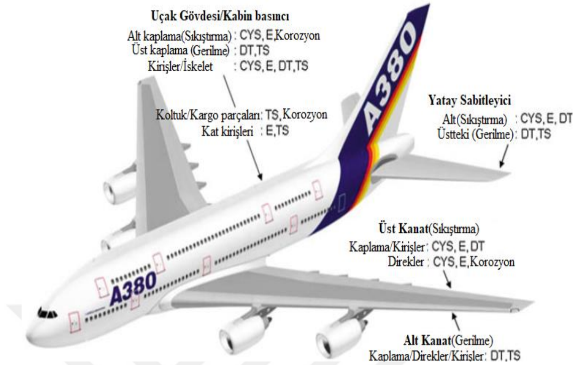
Şekil 1.18 : Bir yolcu uçağının ana yapısal kısımları için mühendislik özellik gereklilikleri (CYS-Compression Yield Strength: Basınç akma mukavemeti; E-Elasticity Modulus: Elastik modülü; TS-Tensile Strength: Gerilme mukavemeti; DT-Damage Tolerance Properties: Hasar tolerans özellikleri (yorulma, yorulma çatlak büyümesi, kırılma tokluğu)) [13].
