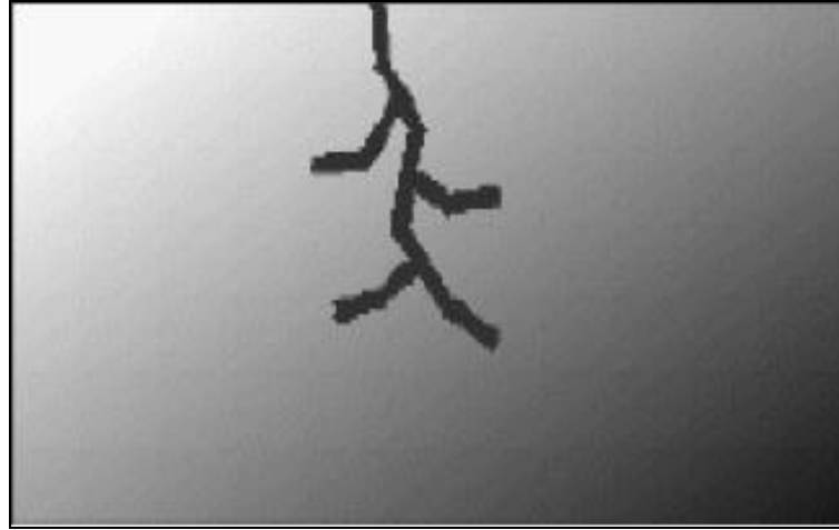
Şekil 1.12 : Gerilmeli korozyon çatlağı [8].
