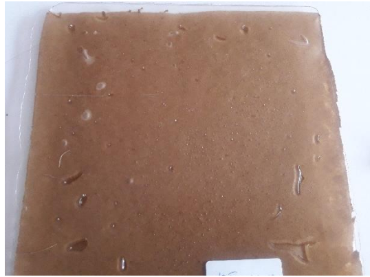
Şekil 3.9: Kraft kağıt takviyeli PLA plakası
