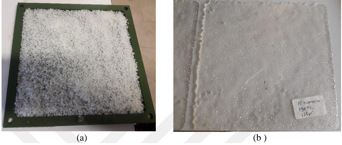
Şekil 3.6: (a) PLA granülerin sıcak press için kalıplanması (b) PLA saf plakalar.
