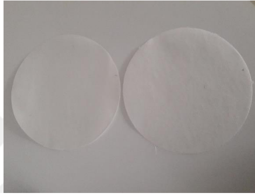
Şekil 3.12: Hazırlanan sisal içeren 100 gr/m 2 'lık kağıt numuneleri.
