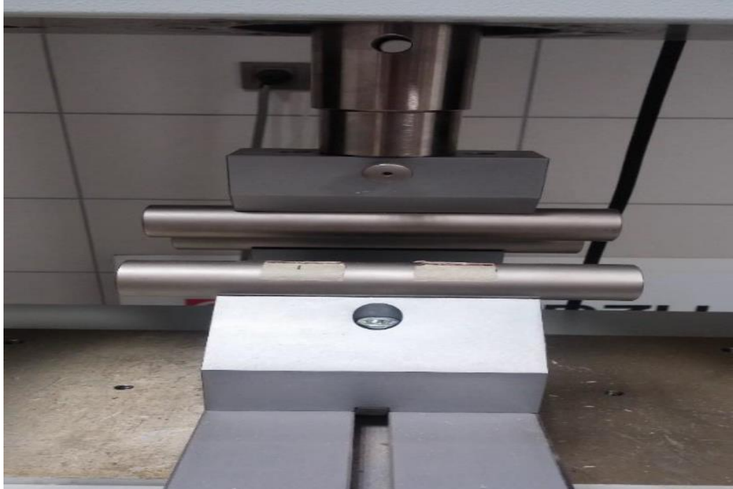
Şekil 3.19: Shimadzu universal test cihazı eğilme testi aparatları
