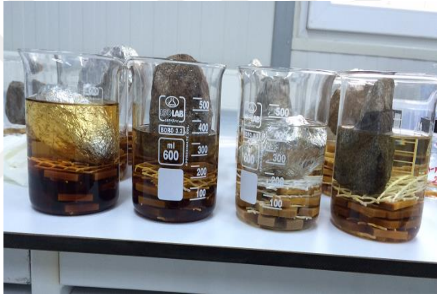
Şekil 3.2 : Biyolojik test öncesi örneklerin yıkanma testine tabi tutulması.
