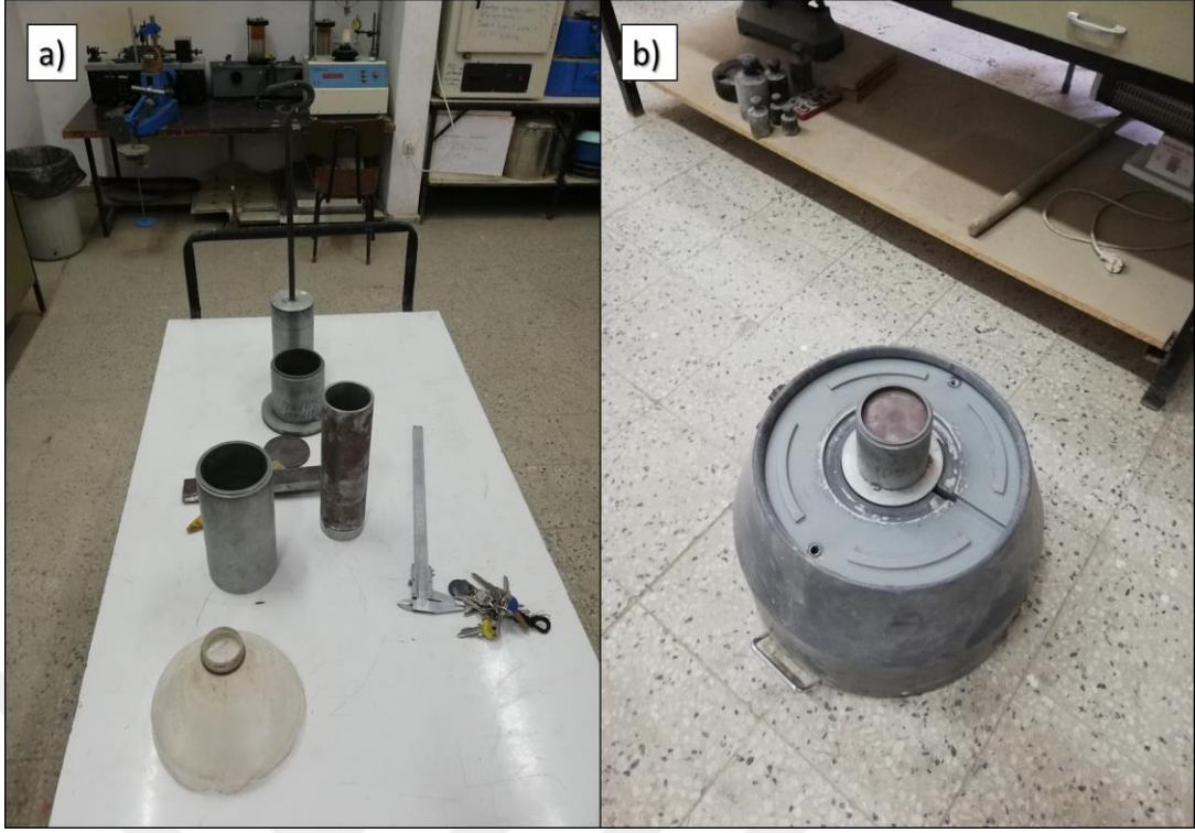
Şekil 3.8 : (a)Minimum ve maksimum boşluk oranlarının bulunması için gerekli aparatlar, (b)titreşim sehpası.
