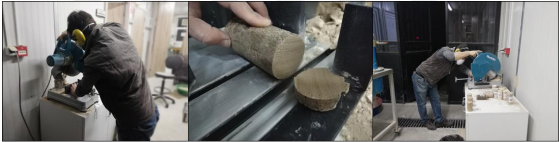
Şekil 3.40 : Numunelerin alt ve üst yüzeylerinin düzeltilmesi.
