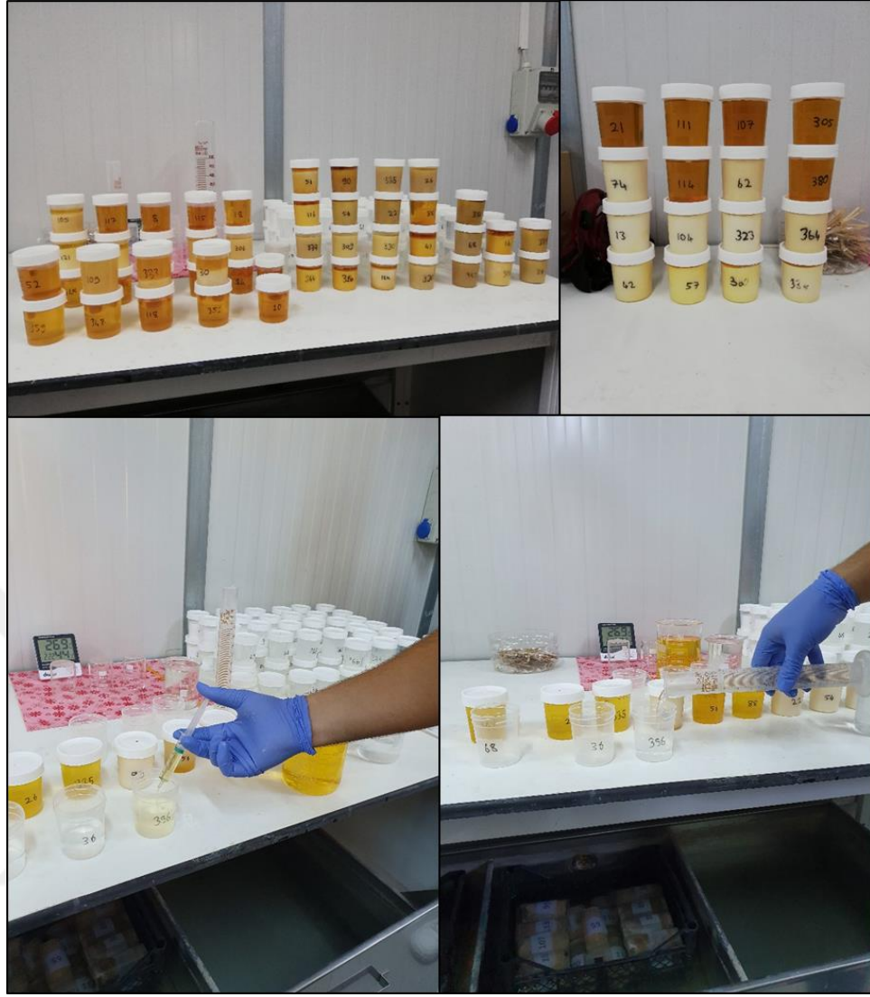
Şekil 3.22 : Glioksal-sodyum silikat karışımların jelleşme deneyleri
