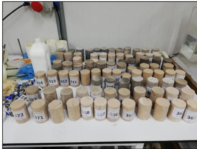
Şekil 3.41 : Düzeltilmiş numunelerin serbest basınç deneylerine hazır hale getirilmesi.
