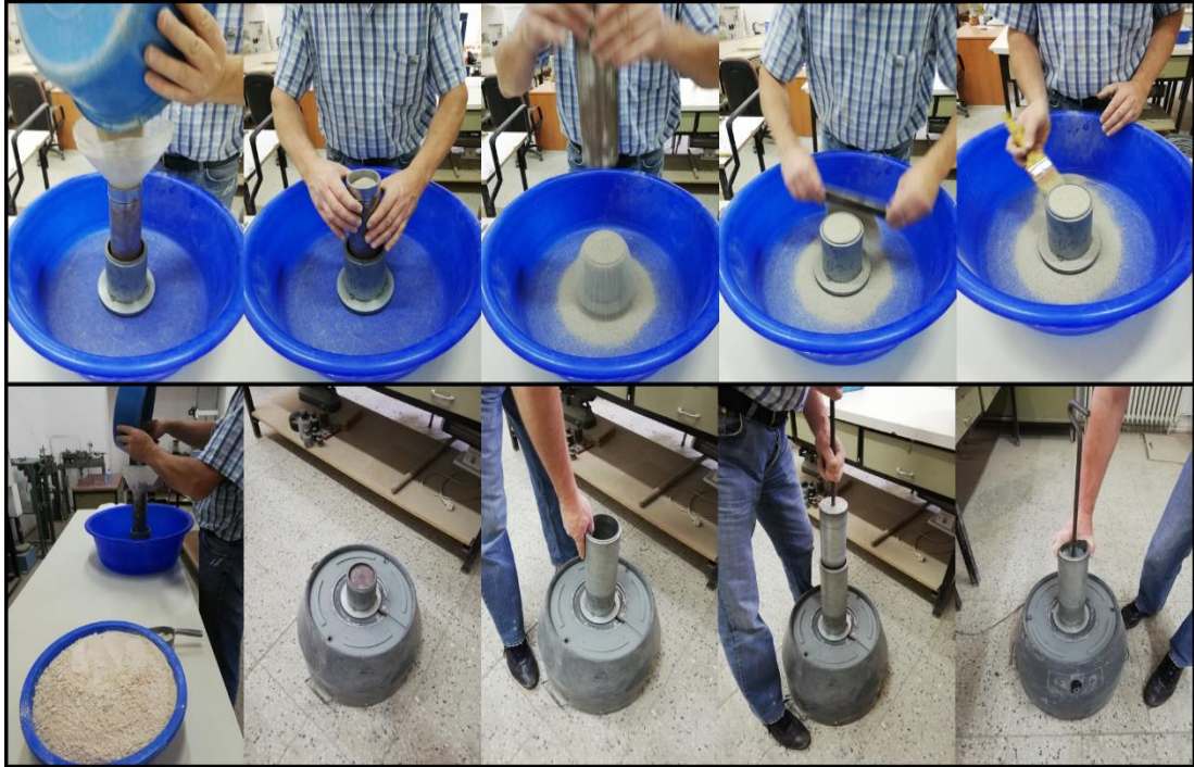
Şekil 3.9 : Farklı gradasyonlarda hazırlanmış silt-ince kum karışımı numunelerin maksimum ve minimum boşluk oranlarının bulunması.
