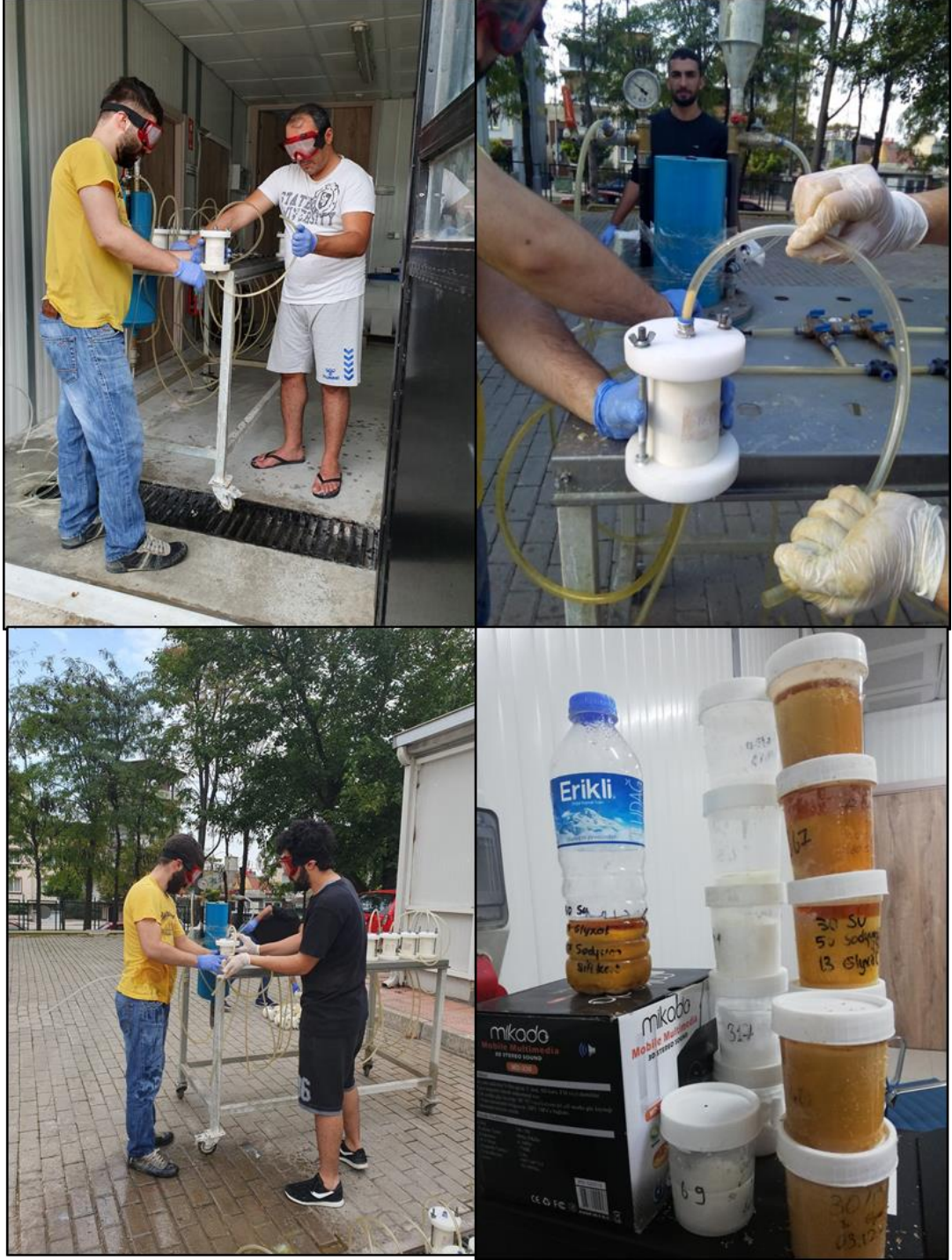
Şekil 3.33 : Enjeksiyon deneylerinin yapılması ve sonrasında tanktan alınan örnekler.
