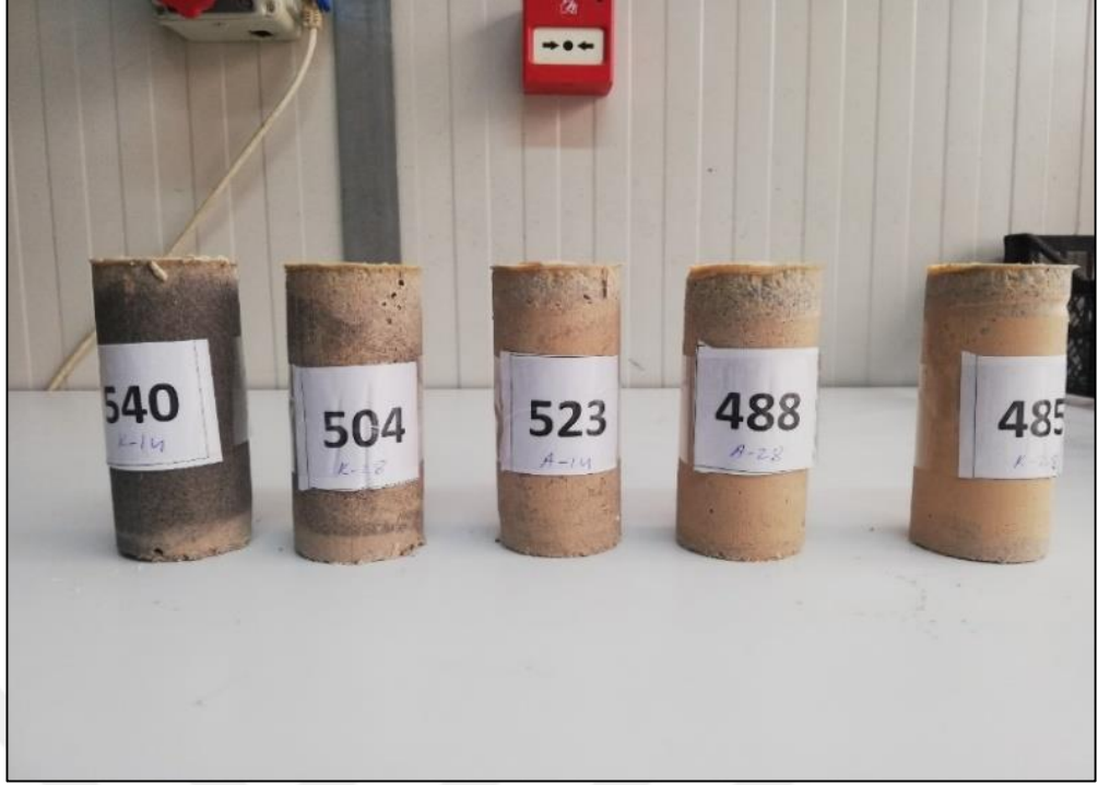
Şekil 3.37 : 5 farklı gradasyonda kimyasal enjeksiyonları başarılı olan numuneler.
