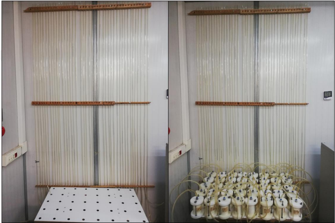
Şekil 3.48 : Düşen seviyeli permeabilite deney düzeneği.
