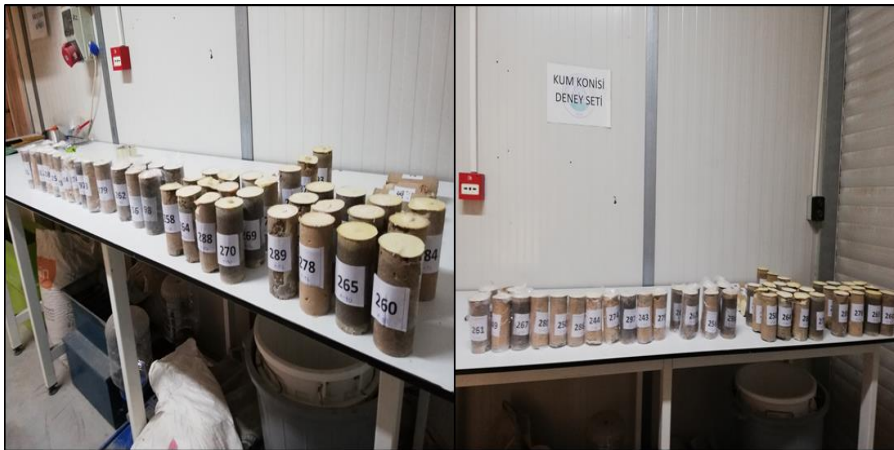
Şekil 3.36 : Moldlardan çıkartılan numunelerin farklı kür koşullarında bekletilmek üzere numaralandırılması.
