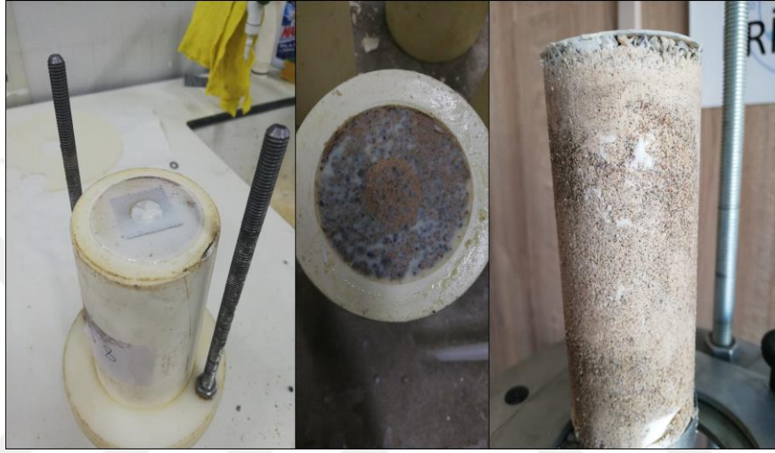
Şekil 3.35 : Jelleşmesini tamamlayan numuneler ve numune krikosu ile moldlardan çıkartılması.
