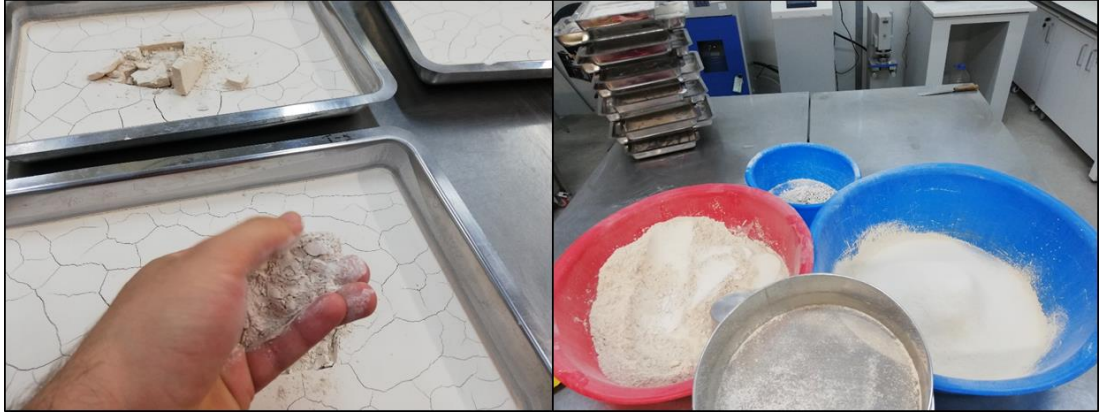
Şekil 3.6 : Etüvde kurutulmuş silt numunenin ufalanması ve elekten geçirilerek saf silt olarak kullanılmak üzere hazır hale getirilmesi.
