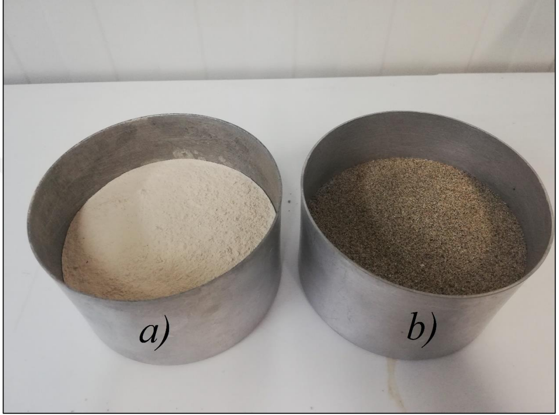
Şekil 3.1 : (a) Saf silte ait görüntü, (b) yıkanmış ve elenmiş ince kuma ait görüntü.
