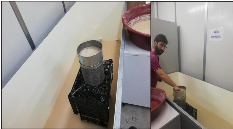
Şekil 3.2 : Araziden gelen silt-kum karışımını numunelerin 200 no.lu elekten yıkanması.
