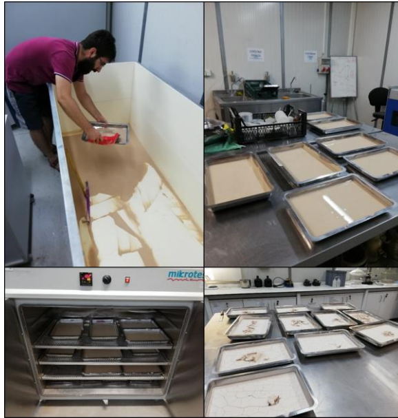
Şekil 3.5 : Çökelmiş silt numunelerin tavalara alınması ve etüve koyularak kurutulma işlemleri.
