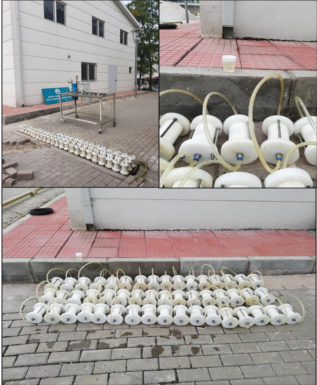
Şekil 3.34 : Deney öncesi enjeksiyon moldlarının hazırlanması ve deney sonrası jelleşme sürelerinin tamamlanması için bekletilmesi.
