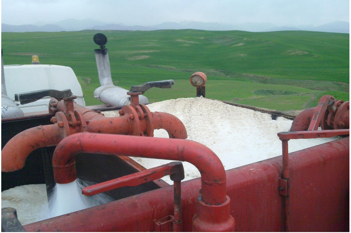
Şekil 3.10. Hazırlanan kimyasalların çimento ile karıştırılması öncesi çimento ünitesine alınması
