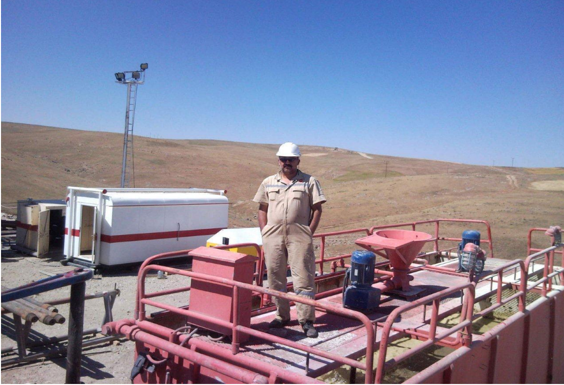
Şekil 3.12. Derin kuyu çimentolama operasyonunda karıştırıcı tanklarda su ve kimyasal karışımı
