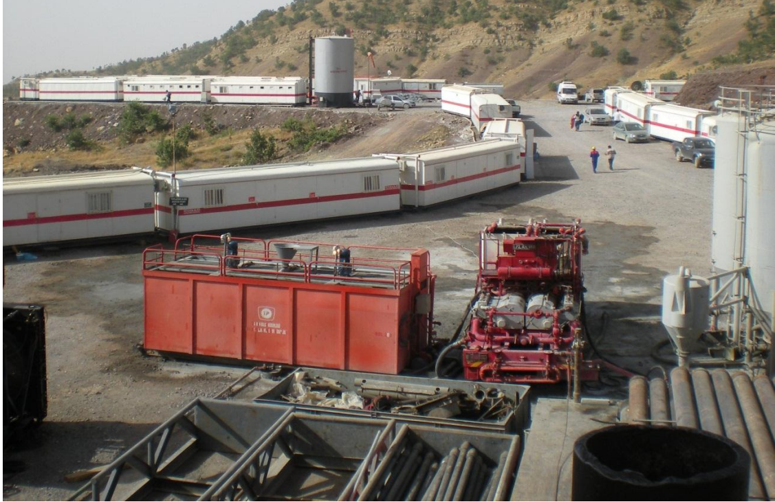
Şekil 3.3. Çimento ekipmanlarının koruma borusu çimentolaması öncesi sondaj kulesi çevresinde yerleşimi
