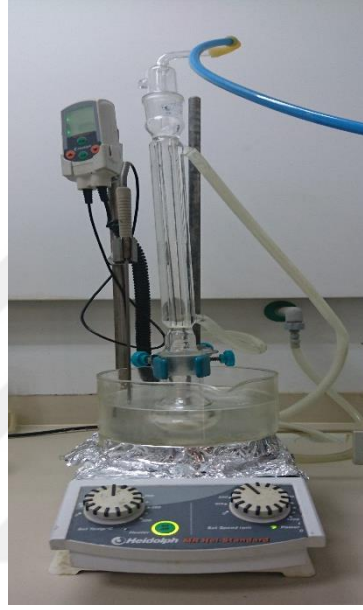
Şekil 2.1: Polimerizasyonda kullanılan reaksiyon düzeneği.
