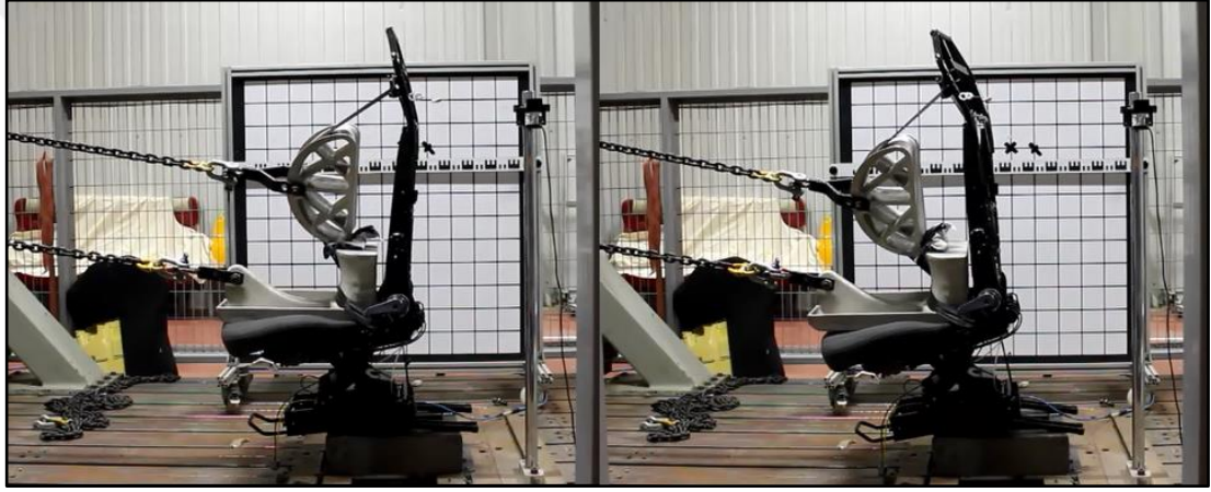
Şekil 3.7: AEK R14 çekme testi sırasında koltuk.
