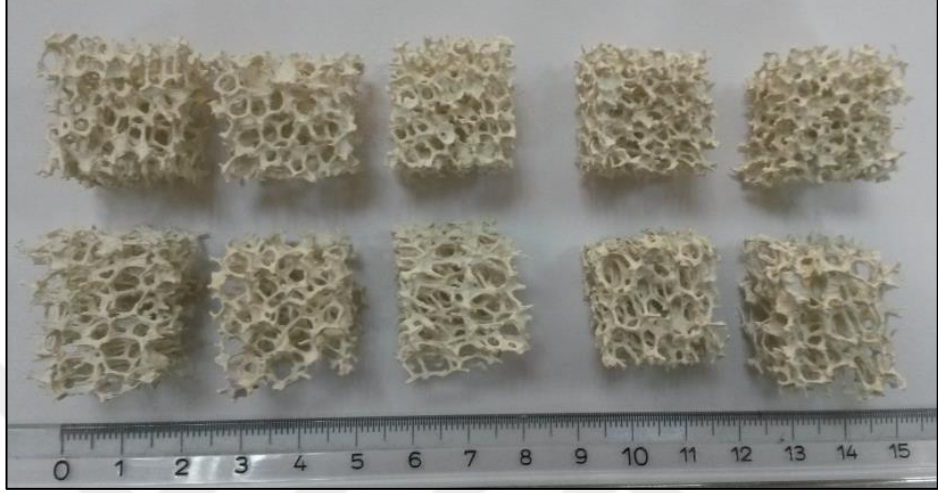
Şekil 2.5 : Yoğunluk ölçümünde kullanılan numunelere ait temsili görsel
