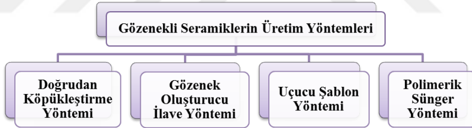
Şekil 1.2 : Gözenekli seramiklerin üretim yöntemleri
