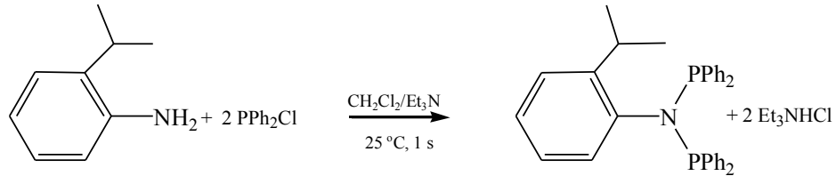
Şekil 3.1. N,N-bis(difenilfosfino)-2-izopropilanilin (1)'in sentezi
