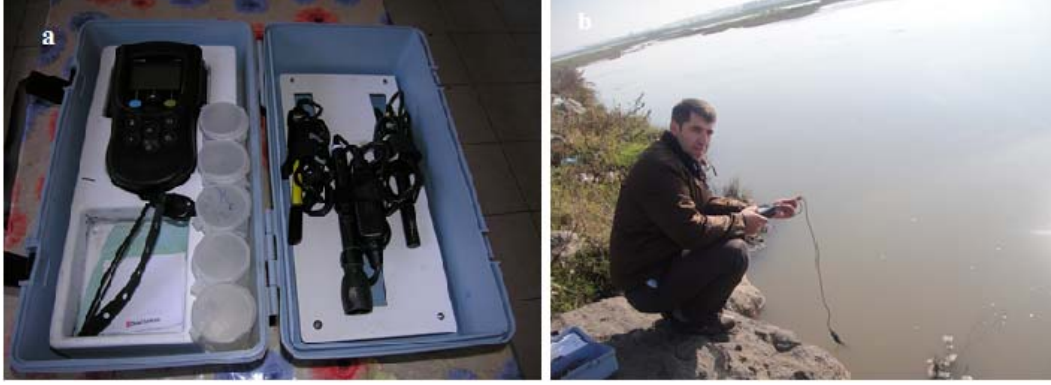
Şekil 3.5. HQ40 multiparametre cihazı (a), HQ40 multiparametre cihazıyla Dicle Nehri'nde ölçüm yapılırken (b)
