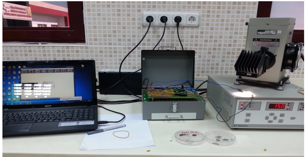
Şekil 3. 28 Güneş Simülatorü ile DSSC'lerin Ölçümlerinin Yapılışı
