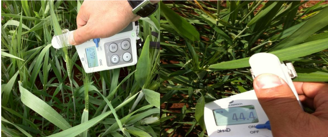
Şekil 3.3. Başaklanma döneminde klorofilmetre (Minolta, SPAD-502) cihazı ile ölçüm yapılması
