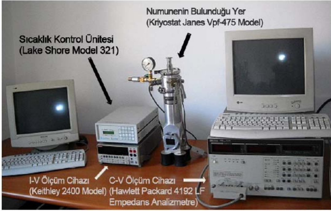
Şekil 3.36. I-V , C-V ve G/\omega-V ölçümlerinde kullanılan deney düzeneğinin fotografik görünümü (Taşçıoğlu 2012)
