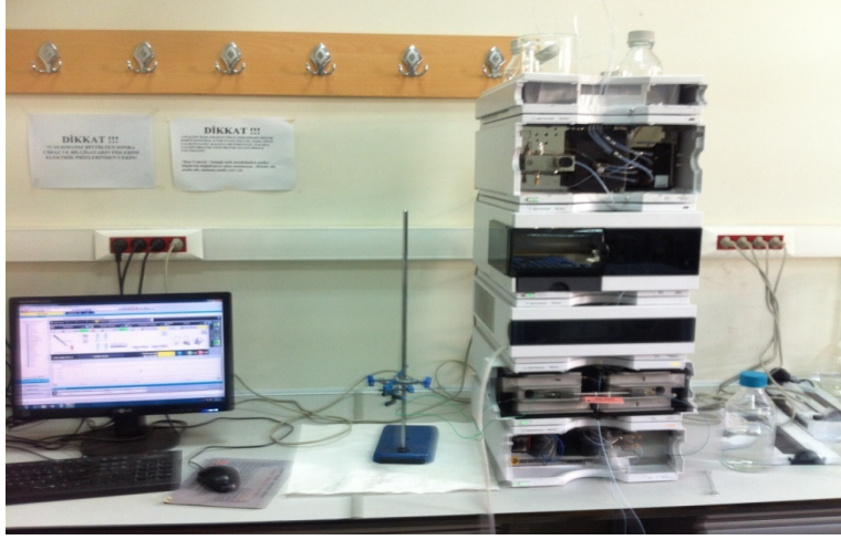
Şekil 4.3. Kolon doldurma ve enantiyomerik rezolüsyon aşamalarında kullanılan HPLC cihazı
