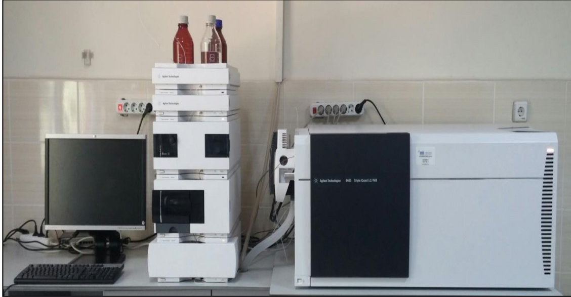
Şekil 3. 1. Akrilamid analizlerinin yapıldığı LC/MSMS cihazı
