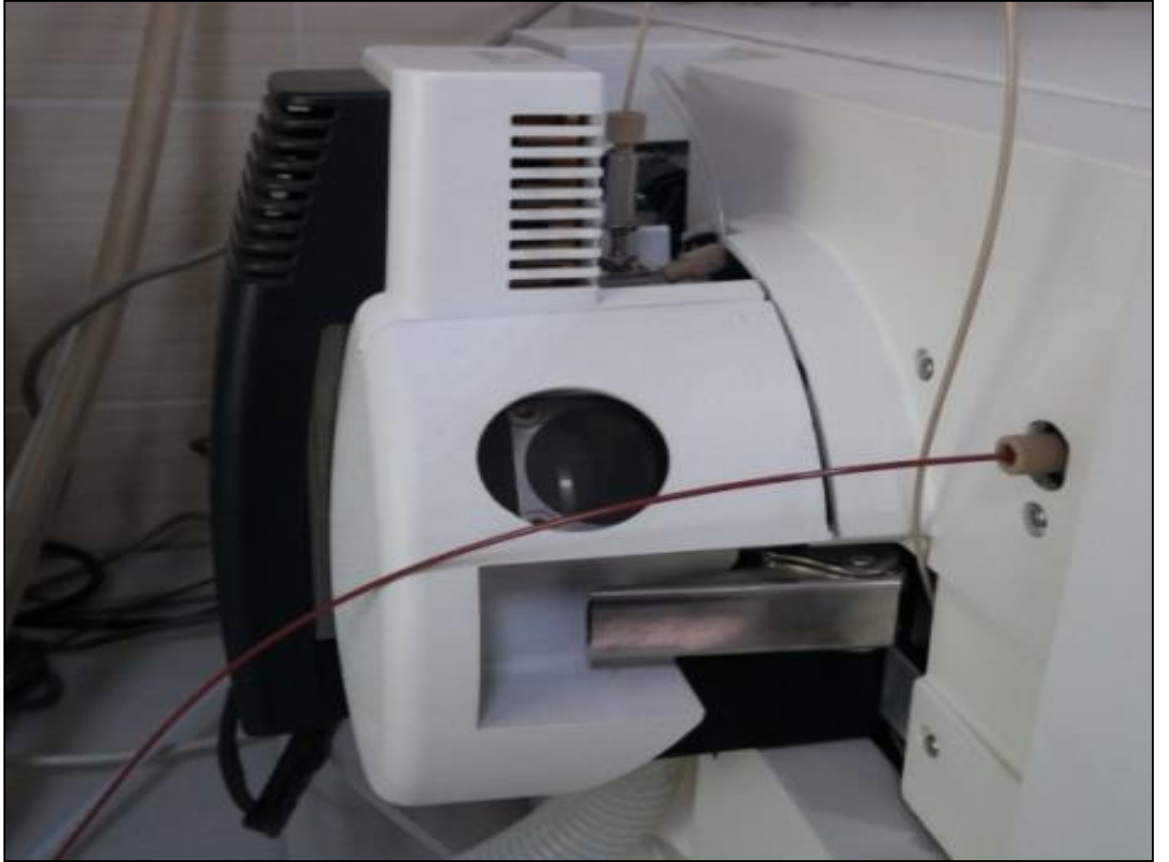
Şekil 2. 12. ESI iyon kaynağı dış görünümü
