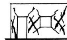
d) Boşluk arası duvar kısımlarının ağır çatlama
