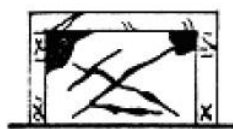
g) Çerçeve de eğik ve kalın çatlaklar
