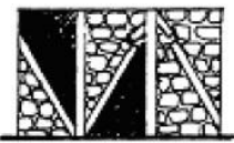
e) Dolgu dökülmesi ve dikmelerde kırılma
