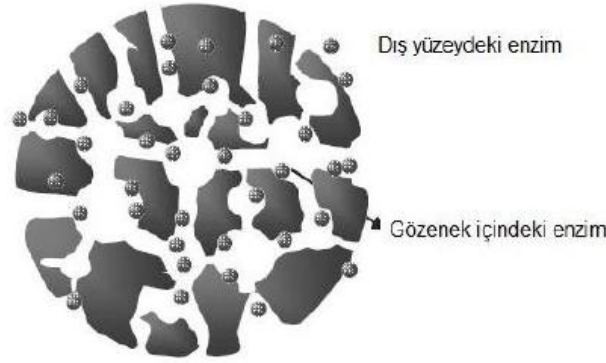
Şekil 2.8. Gözenekli destek maddesinin iç ve dış yüzeyi
