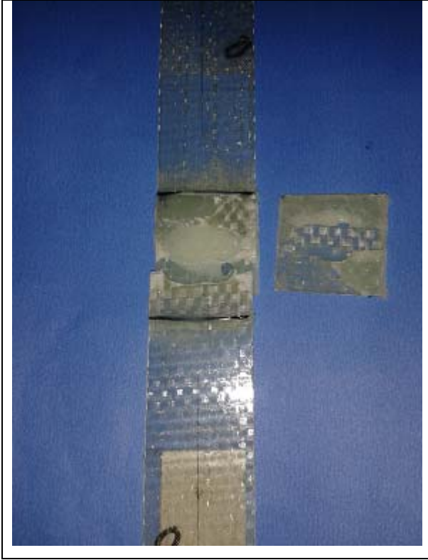
Şekil 5.30. [0^0]_8 Tip1 çift yüz Lap=30 mm yamalı numunenin hasar sonrası levha ve yamanın durumu
