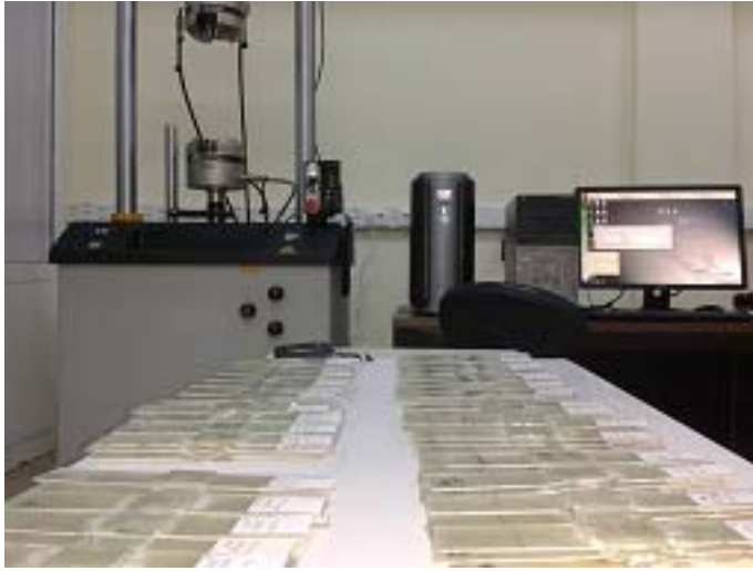
Şekil 4.16. Çekme test cihazı ve deney düzeneği
