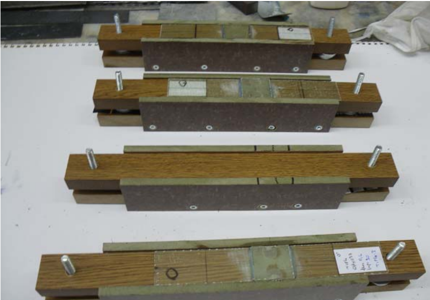
Şekil 4.12. Yamanın yapıştırıcı sürüldükten sonra kalıba oturtulması
