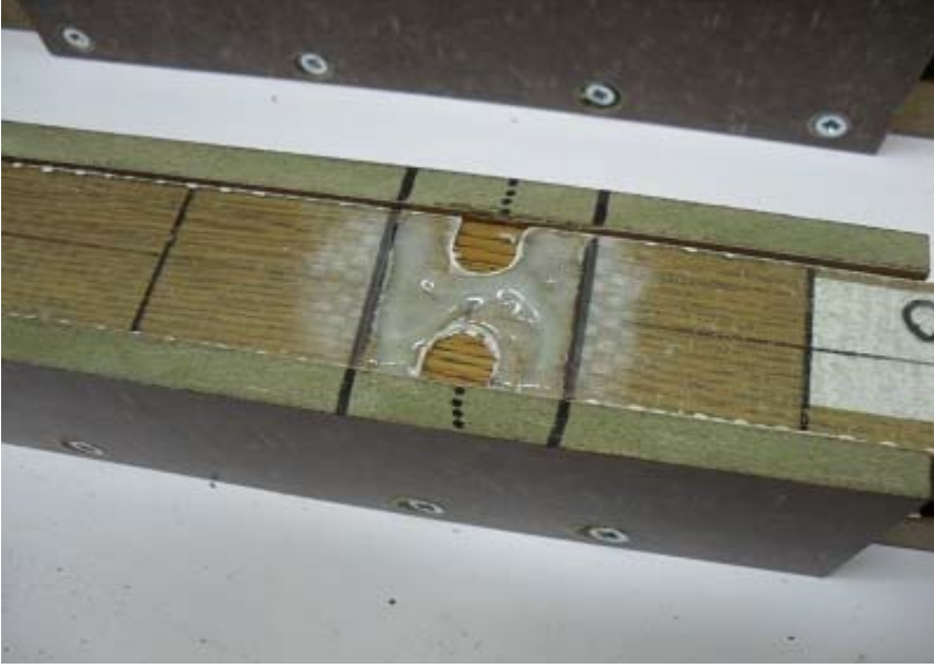
Şekil 4.11. Yama uygulaması için kalıba yerleştirilen levhaya yapıştırıcı sürülme işlemi
