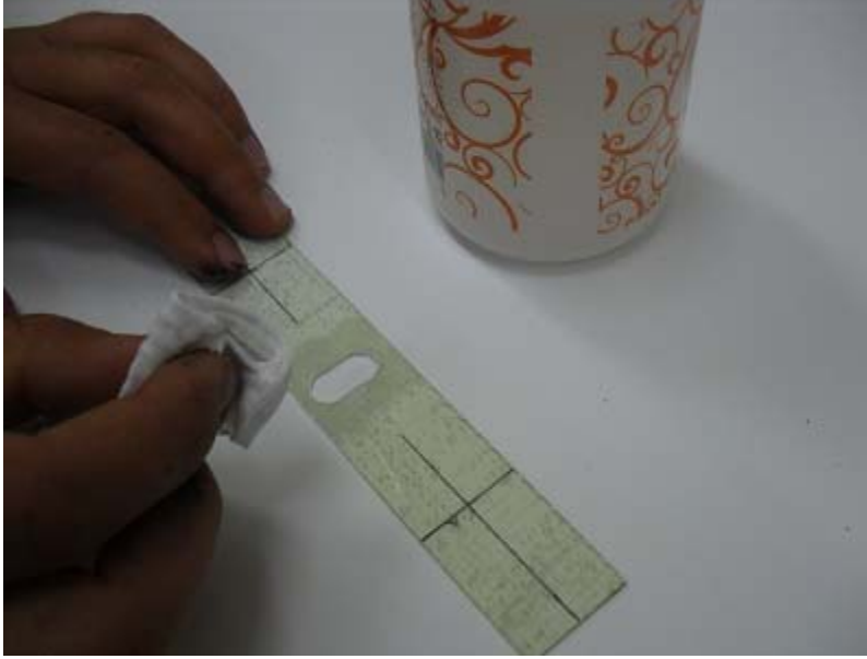
Şekil 4.9. Zımparalanan levhaların aseton ve bezle silinmesi işlemi
