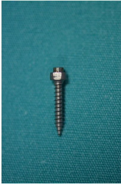
Şekil 3.1: 2 mm çaplı 11 mm uzunluktaki mini-vida (Arno Fritz GmbH)
