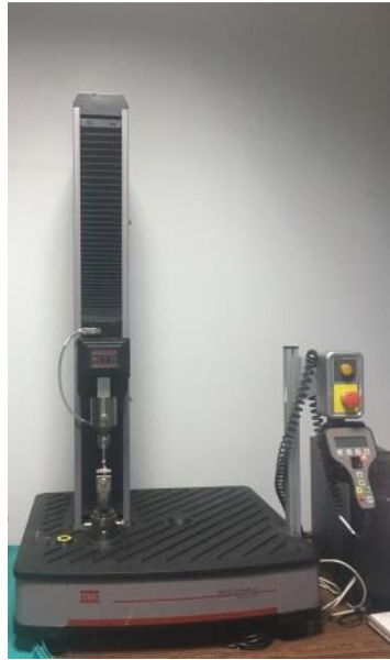
Şekil 3.19. MTS marka (Criterion model, USA) C42.503 model evrensel test cihazı
