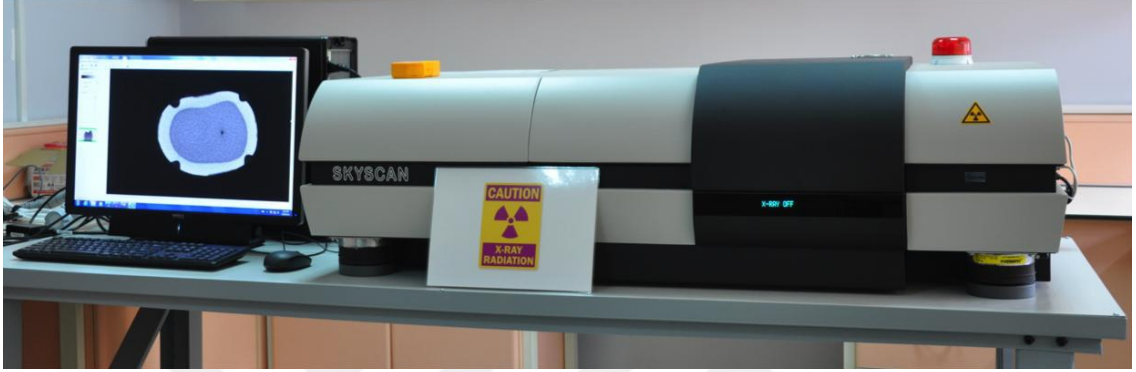
Şekil 3.5. Çalışmada taramalar için kullanılan Skyscan 1172 Mikro-BT sistemi
