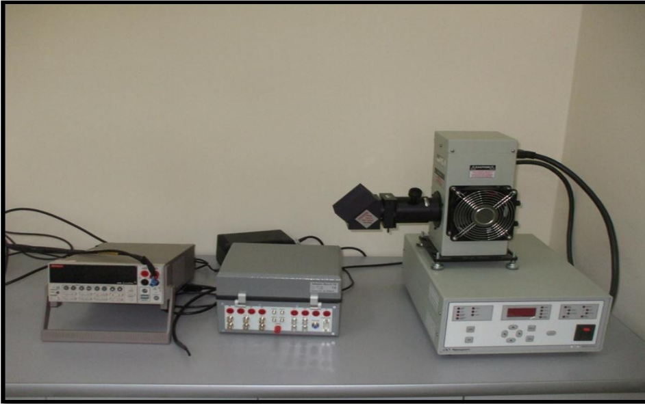
Şekil 3.15. Keithley 2400 Sourcemeter ve güneş simülatörü
