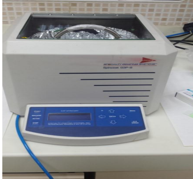
Şekil 3.13. İnce Filmin Oluşturulduğu Dönel Kaplama Cihazı
