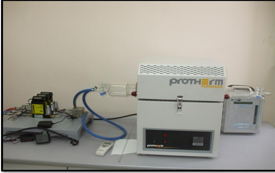
Şekil 3.12. Tavlama İşleminin Gerçekleştirildiği Fırın
