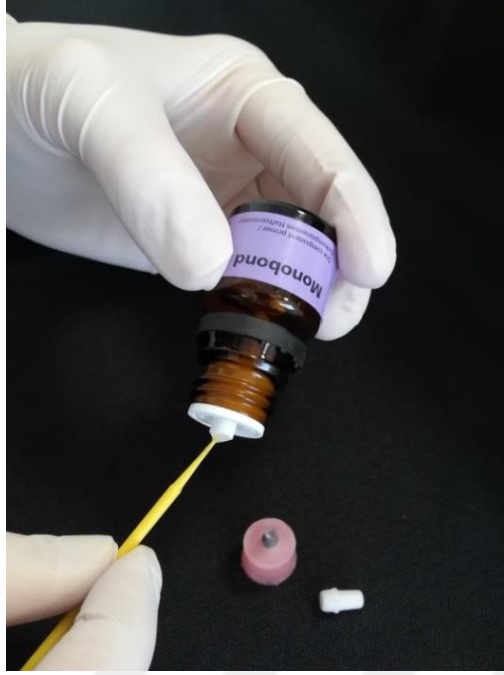
Şekil 3.10. Titanyum taban ile kopinglerin bağlanma yüzeyine primer uygulaması
