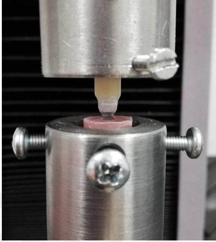
Şekil 3.31. 0° açılı abutment numunelerinin yerleştirilmesi
