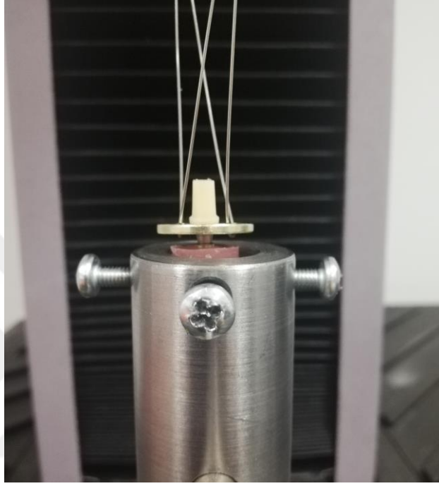
Şekil 3.33. Abutmentların çekme testi için cihaza yerleştirilmesi
