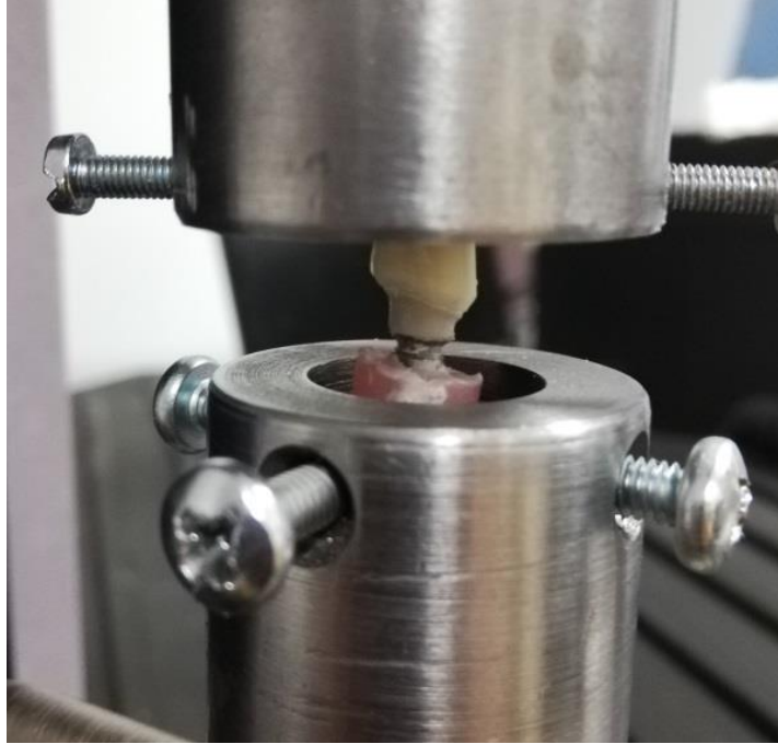
Şekil 3.32. 15° açılı abutment numunelerinin yerleştirilmesi
