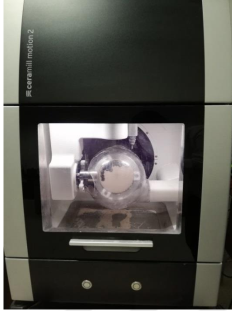
Şekil 3.6. PEEK abutmentların frezelenmesi
