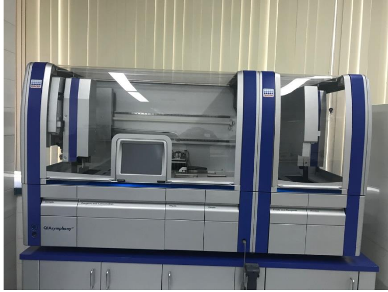
Şekil 3.7. Qiasymphony SP otomatize ekstraksiyon sistemi
