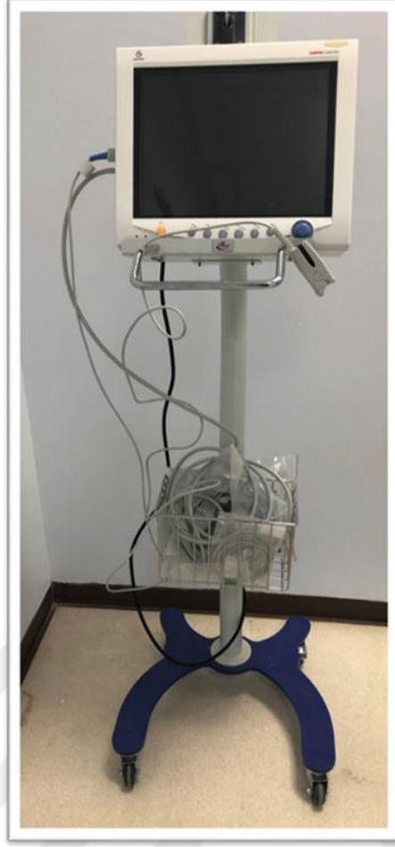
Şekil 3.4. Çalışmada kullanılan hasta başı monitörü cihazı (Contec Marka CMS Model)
